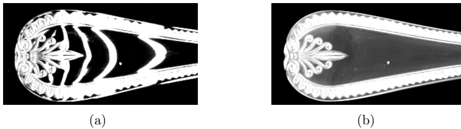
Figure 5.23 – Détection de défauts d'aspect sur des objets métalliques spéculaires : (a) effets de l'éclairage structuré au niveau des décors, (b) image d'aspect.
