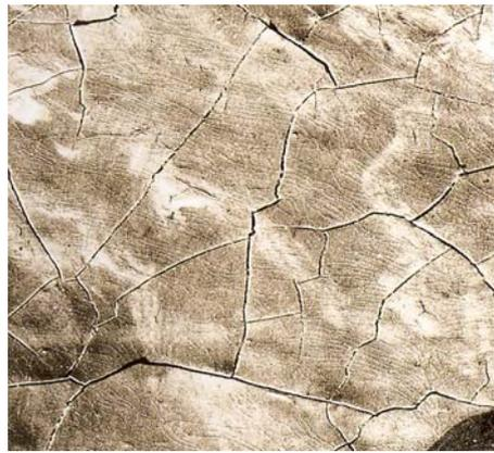
Figure 1 : exemple de faïençage d'une couche de vernis (photo [21] )
