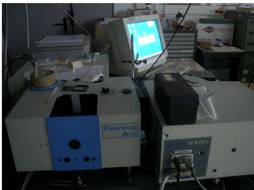
Figure 7 : Spectrofluorimètre Fluorolog-3 de la société Jobin-Yvon
