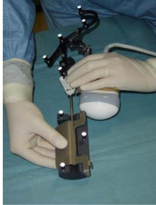
*Figure 50 : Calibration du trajet de ponction échographique. La détermination de l'axe dans le référentiel échographique se fait en obtenant deux acquisitions de la position du guide avec une variation angulaire de l'ordre de 30°.*
