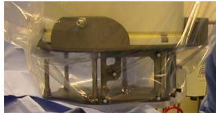
Figure 46 : Mire de calibration fixée sur le fluoroscope.
