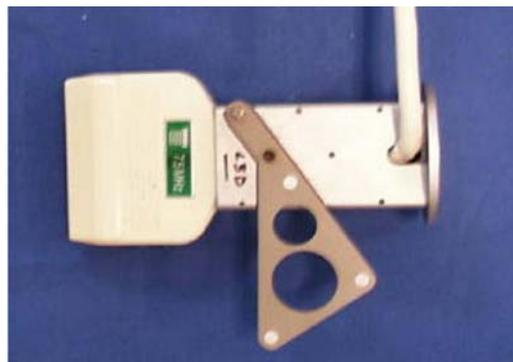
*Figure 18 : Sonde échographique avec rigid body*
