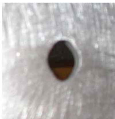
Pho. 8.2 - Usinage de l'aluminium : le trou est ovale
