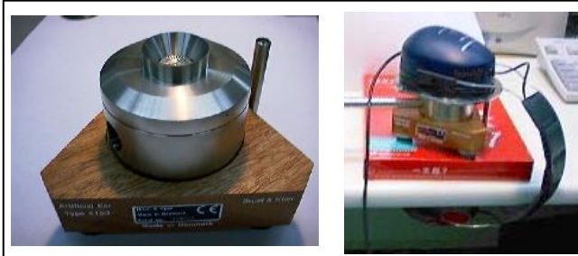
Figure 149. Oreille artificielle B&K 4153 permettant de calibrer avec précision le niveau d'intensité à l'intérieur d'un casque.
