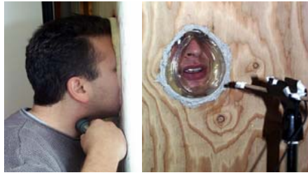
Figure 16. Cloison permettant d'enregistrer la parole du locuteur de façon isolée par rapport à l'environnement sonore qui l'entoure. D'après Meltzner et al. 2003 [237] .
