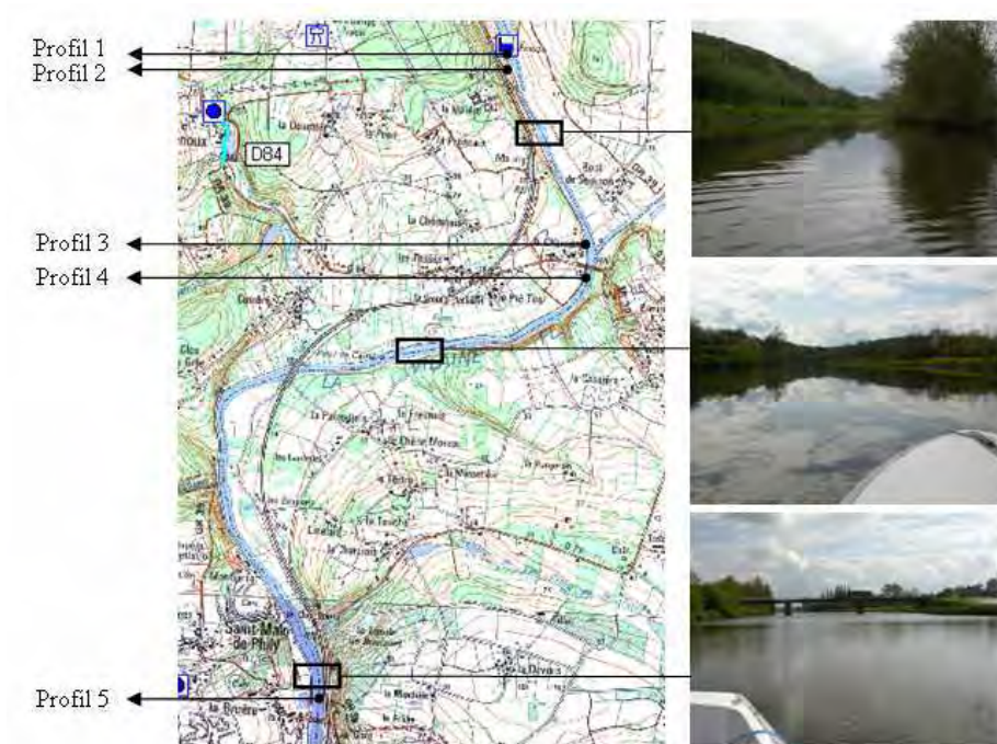
Figure 134 : Positionnement sur carte IGN de 5 profils de vitesses réalisés le 20/05/05 avec le profileur Nivus XPro et visibilité de la Vilaine sur 3 sections particulières.
