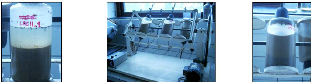
Figure 182 : Mise en œuvre de l'agitation mécanique.
