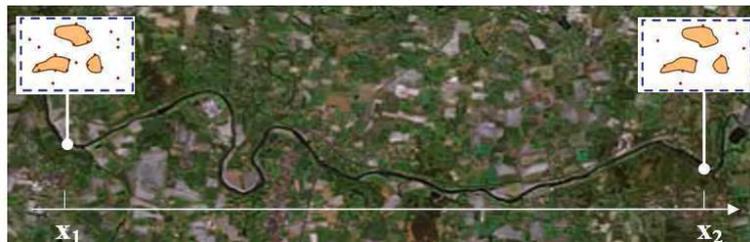
Figure 145 : Schématisation du transfert de particules entre les points  $x_1$  (amont) et  $x_2$  (aval) d'une rivière distants de  $L$ . La concentration en radioéléments entre  $x_1$  et  $x_2$  diminue suivant la loi de décroissance radioactive.
