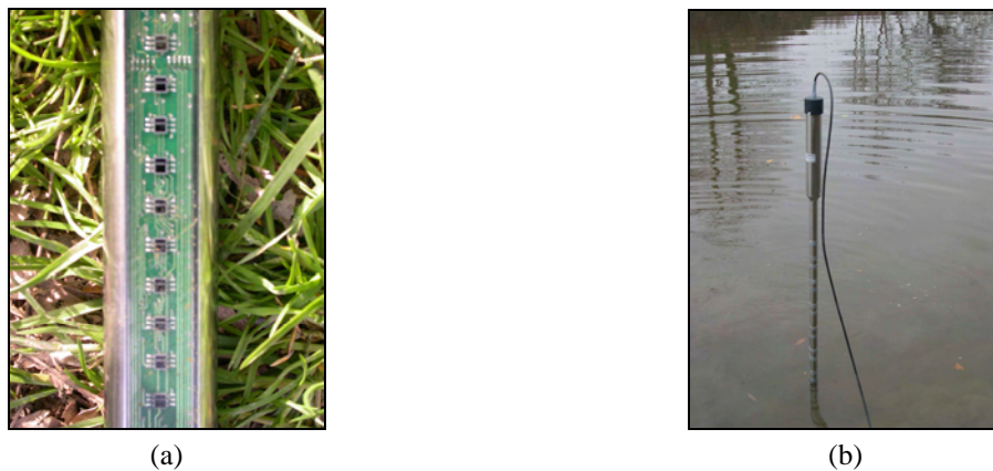
Figure 87 : (a) Photographie de 10 des 144 capteurs, et (b) instrument en configuration de travail avec son capuchon de récupération des données.
