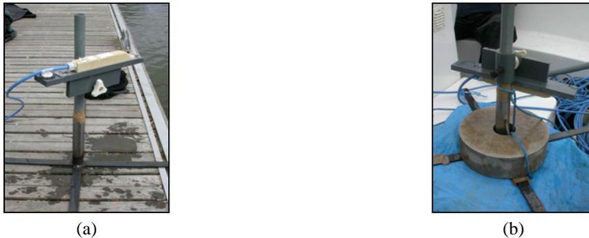
*Figure 68 : Profileur de vitesse Nivus XPro (a) et (b) sur son support lesté (b). (a) : configuration de mesure avec visée vers la surface libre ; (b) : configuration de mesure avec visée vers le lit de la rivière.*
