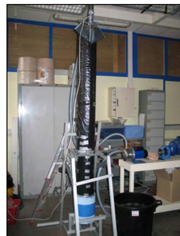
Figure 88 : (a) courbe d'étalonnage moyenne de l'ASM-IV Argus à partir des sédiments de la Vilaine (la variabilité est déterminée à partir des moyennes des 144 capteurs) ; (b) dispositif d'étalonnage : perche placée dans un tube PVC et circulation (de haut en bas) du fluide (eau + sédiments) assurée par une pompe. La partie basse du tube est conique pour éviter les zones locales de dépôt et l'ensemble est protégé de la luminosité ambiante.
