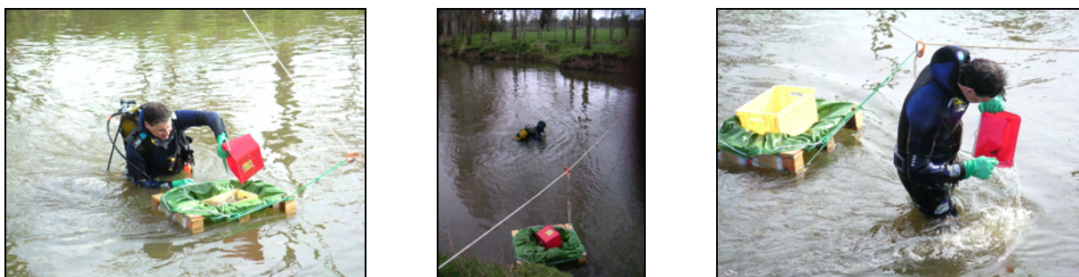
Figure 176 : Exemple de mise en œuvre des prélèvements par raclage du fond (Meu, affluent de la Vilaine).
