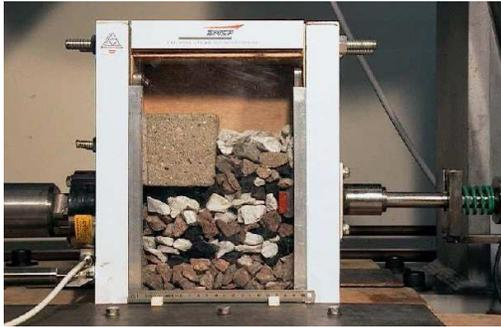
**Figure 1.25:** Banc d'essai bouba (BOUrage du BALLast). Les vibrations sont appliquées sur une boîte délimitée par une paroi en plexiglas. Une plaque bourroir se déplace horizontalement avec une amplitude contrôlée [86].
