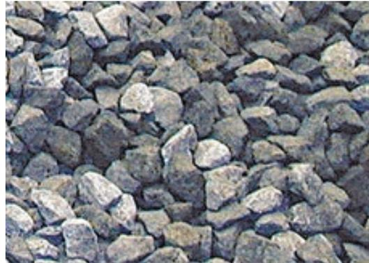
*Figure 1.2: Ballast ferroviaire.*
