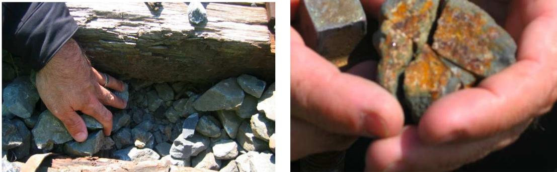
**Figure 2.48:** Grains de ballast brisés et état du ballast sous le blochet suit au passage de la bourreuse. Photographie prise lors d'une opération de maintenance près de Nîmes. Dans ce cas, la fréquence de vibration des bourroirs est de 35 Hz.
