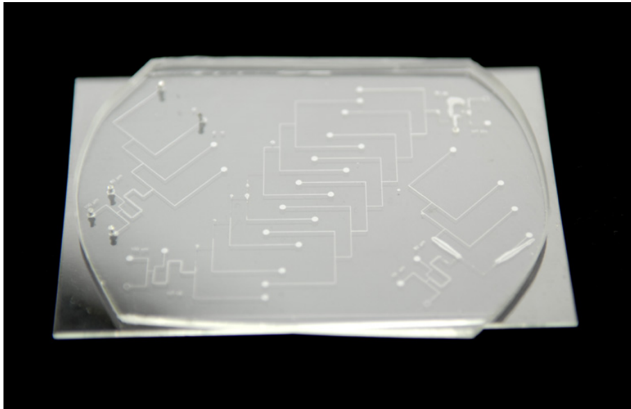
FIG. 7.3 – Un réseau de microcanaux en verre et PDMS
