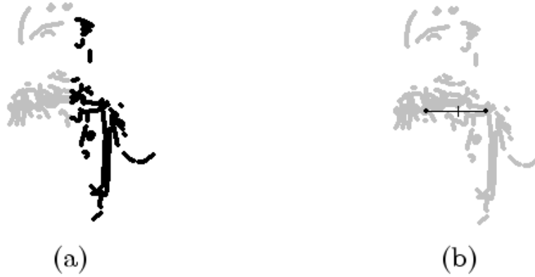
FIG. 5.11 – Création de l'objet factice : (a) séparation des points en deux sous-ensembles par rapport à son centre de gravité, (b) représentation des points clés du segment factice.
