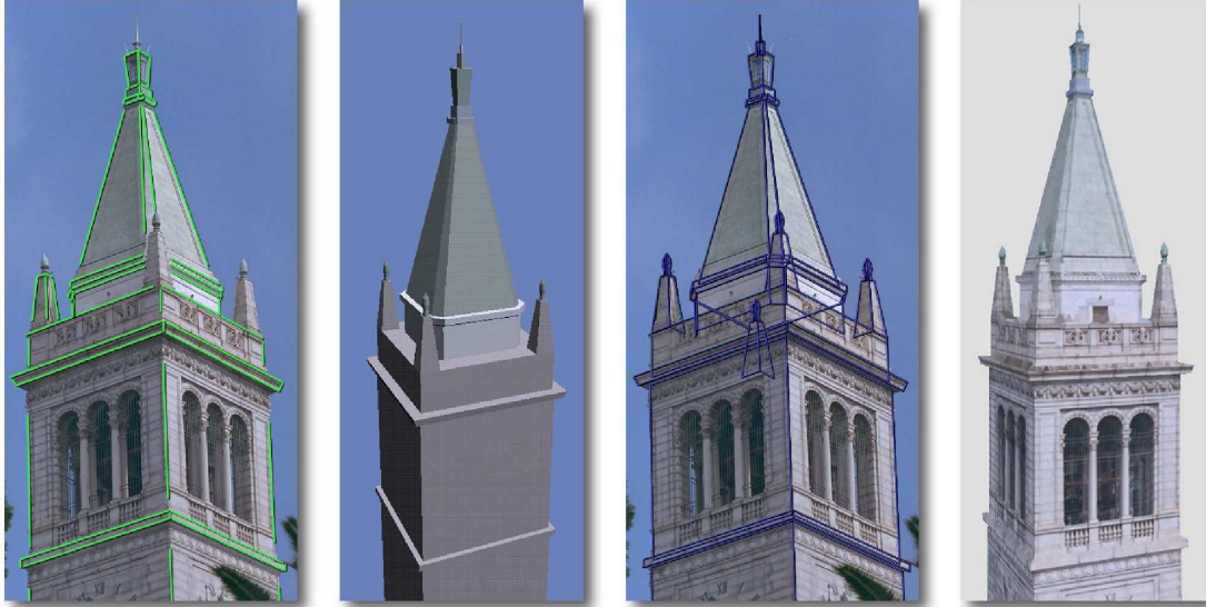
FIG. 2.28 – De gauche à droite : photographie originale avec marquage des arêtes ; modèle reconstruit ; reprojection du modèles fil de fer sur la photographie ; rendu de l'image de synthèse. (image P. E. Debevec, C. J. Taylor et J. Malik ©1996 ACM)
