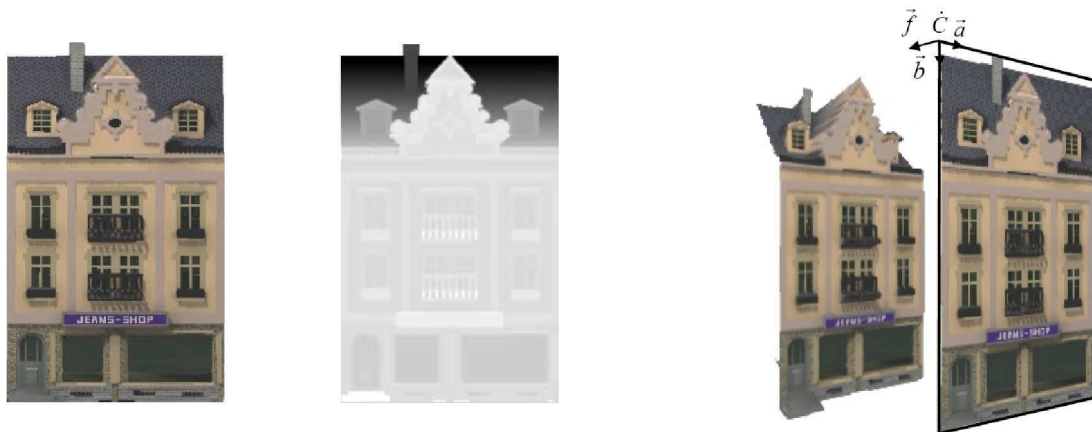
FIG. 2.25 – De gauche à droite : texture de l'image et carte de profondeur ; texture de l'image avant et après transformation. (Images M. M. Oliveira 2000)
