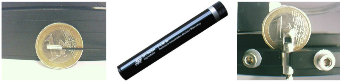
FIG. 2.1 – De gauche à droite : fibroscope ( \phi 1\text{ mm} ) ; mini-microscope TIMM ( 155\text{ mm} \times \phi 22\text{ mm} ) ; mini-caméra endoscopique ( 20\text{ mm} \times \phi 5\text{ mm} ).
