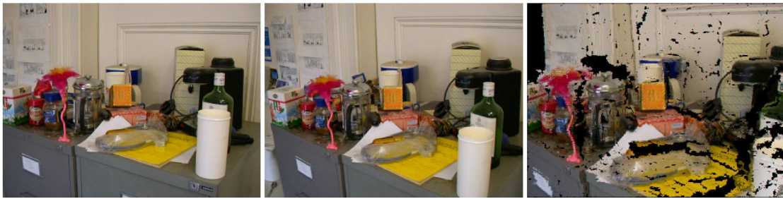
FIG. 2.23 – Couple d’images stéréo à gauche et le rendu à droite de la nouvelle vue par transfert trifocal. (Images K. Connor et I. Reid ©2002 BMVC)
