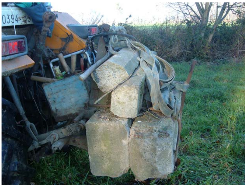
Fig. 28 : contreponds à l'arrière du tracteur
