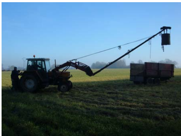
Fig. 27 : " panier " bricolé avec des bidons recyclés et attaché à la fourche du tracteur.
