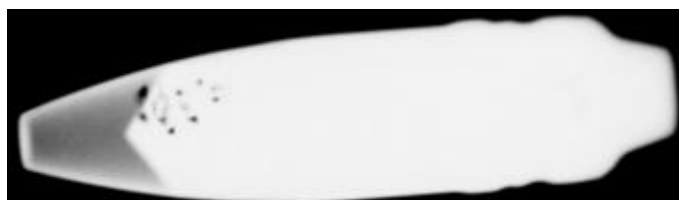
Figure 27 : Radiographie d'un projectile en vol à 700 \text{ m s}^{-1} obtenue avec une impulsion de 20 ns (source SPHINX, autorisation reproduction DGA-ETBS)
