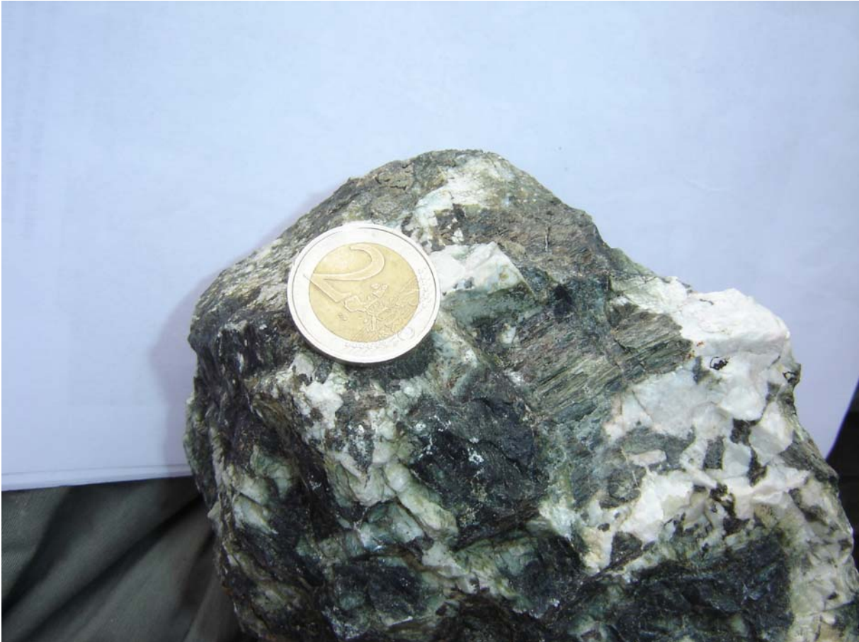
« le gabbro a une structure grenue dûe a son refroidissement lent,lors de la remonté de l'asthénosphère vers la surface,témoin de l'ouverture d'un océan . On observe des plagioclase blancs et des pyroxènes en feuillets. »
