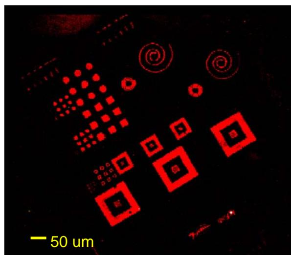
**Figure 5 :** Exemple de motifs de molécules d'ADN fluorescentes de  $100\ \mu\text{m}$  à  $2\ \mu\text{m}$  déposés par  $\mu\text{CP}$  sur une lame de verre, imagées à l'aide d'un scanner de fluorescence
