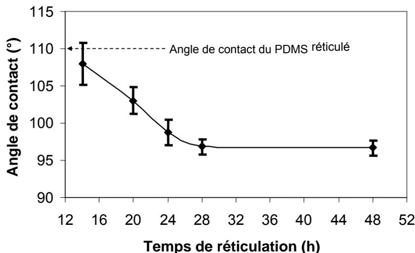
**Figure 8 :** Dépendance de l'angle de contact final ( $\alpha_p$ ) eau-substrat (substrat de verre) après impression d'un timbre plat de PDMS Sylgard 184® (temps de contact : 1 minute) en fonction du temps de réticulation du PDMS à 60°C. Les barres d'erreur correspondent à différentes mesures combinées avec l'incertitude de mesure de l'angle de contact. La flèche horizontale indique l'angle de contact de l'eau sur le PDMS réticulé.
