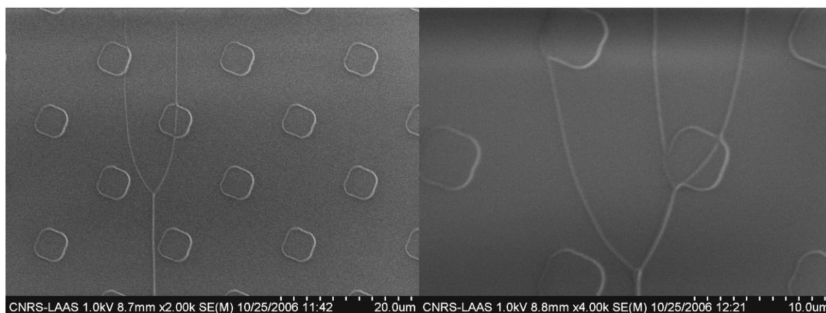
**Figure 23 :** Images MEB d'un peignage d'ADN phage- $\lambda$  sur un timbre de PDMS. Le réseau de motifs carrés sans parapet a été orienté à  $45^\circ$ . Les cordes proches les unes des autres sont attirées entre elles par la déformation du ménisque de peignage et forme des cordes plus épaisses.
