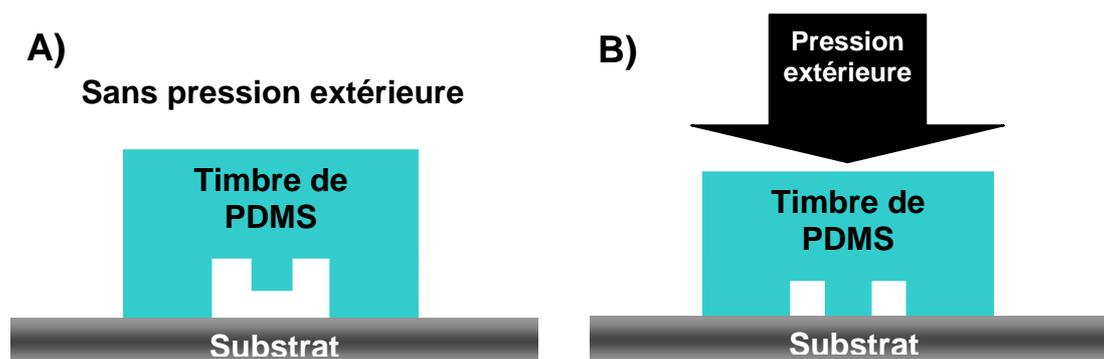
**Figure 16 :** *A) Timbre avec deux niveaux de structures en contact conforme avec le substrat, sans force extérieure appliquée. Seul le premier niveau de structure est en contact avec le substrat. B) Une pression extérieure est appliquée uniformément sur le timbre. Celui-ci se déforme amenant le deuxième niveau de structure en contact avec le substrat.*
