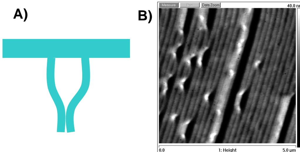
**Figure 14 :** A) Représentation schématique du collapse latéral d'un timbre de PDMS. B) Image AFM du collapse latéral d'un timbre de PDMS. Réseau de lignes de 100 nm au pas de 200 nm avec un facteur de forme  $h/2a=2,5$ .
