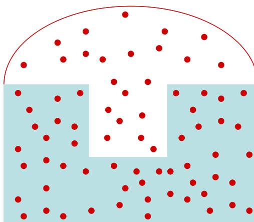
**Figure 10 :** Schématisation du processus d'encrage de petites molécules dans des solvants polaires aprotiques sur un timbre structuré en PDMS. Les points rouges représentent les molécules de l'encre. Elles se répartissent de façon homogène sur la totalité du volume du timbre.
