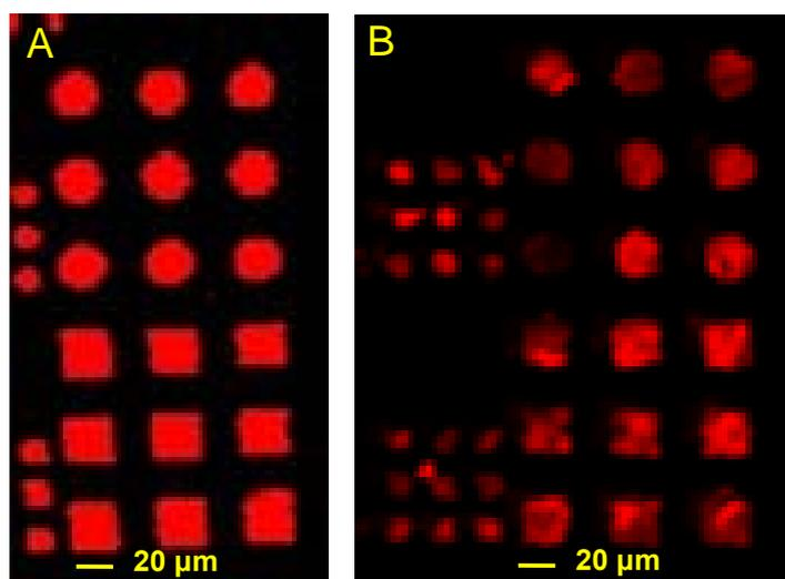
**Figure 7 :** Image en fluorescence des dépôts d'ADN par  $\mu$ CP sur une lame de verre. L'image (A) sur la gauche correspond à une impression réalisée avec un timbre de PDMS non nettoyé contenant des motifs micrométriques compatibles avec la caractérisation en fluorescence. L'image (B) correspond une impression réalisée exactement dans les mêmes conditions avec un timbre de PDMS nettoyé au Soxhlet.
