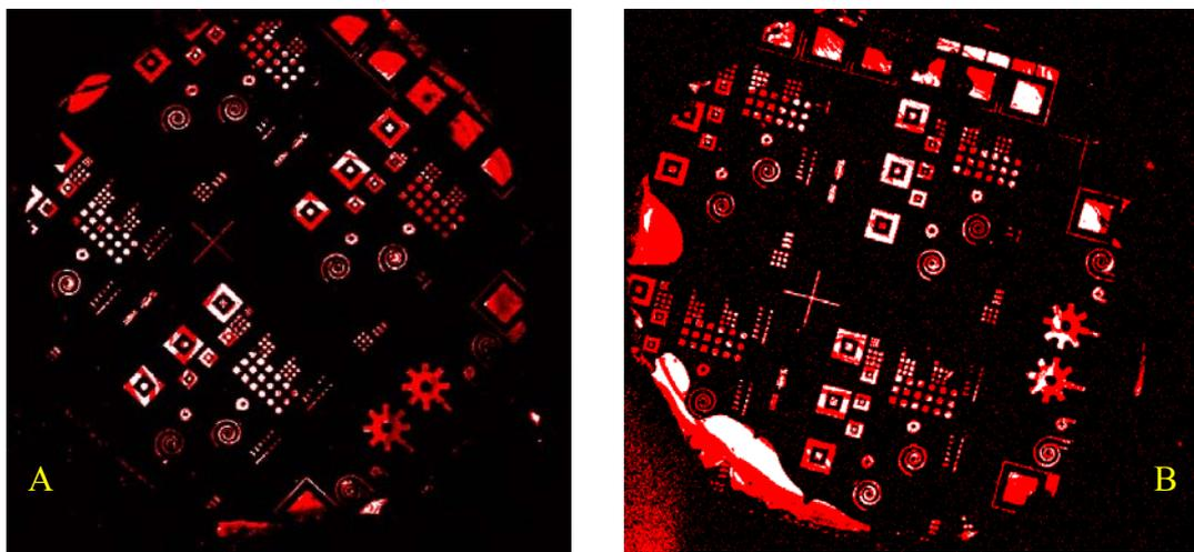
**Figure 6 :** (A) 30 s d'encrage, (B) 1 H d'encrage; Les temps de contact pour A et B sont de 1 min sur lame de verre. Les zones blanches des motifs correspondent à une saturation du signal de fluorescence du scanner.
