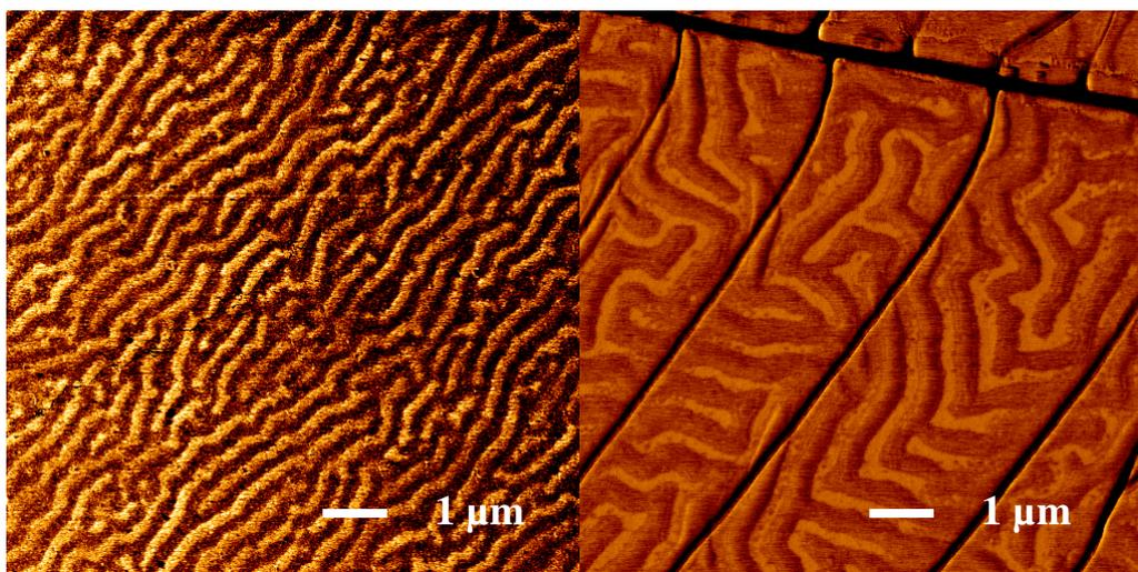
**Figure 2 :** Image AFM  $10\ \mu\text{m} \times 10\ \mu\text{m}$  d'une surface de PDMS ayant subi un traitement plasma  $\text{O}_2$ , l'échelle en  $z$  est de  $5\ \text{nm}$ . A gauche le PDMS à été exposé à un plasma oxygène  $200\ \text{W}$  pendant  $1\ \text{min}$ . A droite le PDMS à été exposé à un plasma oxygène  $200\ \text{W}$  pendant  $5\ \text{min}$ .
