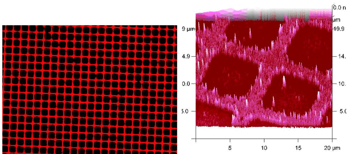
**Figure 9 :** *A gauche, image en fluorescence d'un dépôt de protéines (BSA-rhodamine 100 $\mu$ g/ml, encrage 30 s, contact entre le timbre et le substrat 15 s). Les carrés noirs ont une largeur de 10  $\mu$ m et les lignes rouges de BSA une largeur de 2 $\mu$ m. A droite une image 3D AFM du dépôt présenté à gauche.*
