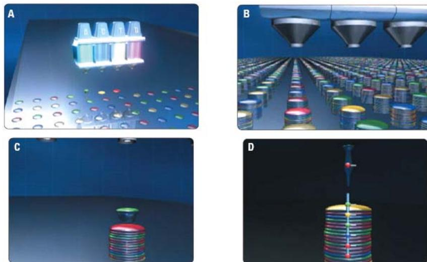
**Figure 22 :** Méthode de synthèse in-situ Agilent. **A** un premier dépôt constitué du premier niveau de bases est effectué sur la surface activée de la puce. **B** superposition des différentes bases. **C** zoom sur un spot en cours d'ajout de base sur la chaîne d'ADN **D**.
