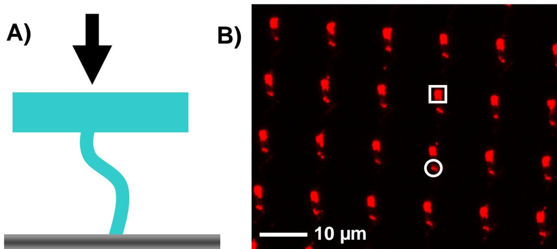
**Figure 15 :** A) Représentation schématique du Buckling d'un timbre de PDMS. B) Image en Epifluorescence de BSA rodhamine déposé par  $\mu$ CP sur une lame de verre. Le cercle entoure le type de dépôt ou le premier contact avant Buckling à eu lieu. Le carré entoure le type de dépôt après relâche de la contrainte due au Buckling.
