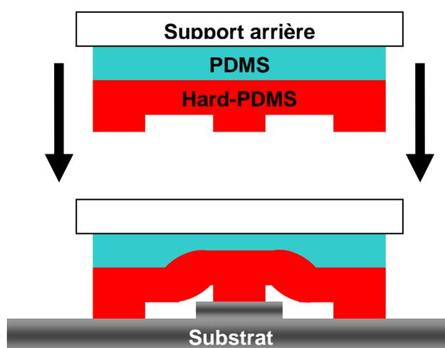
**Figure 5 :** Exemple d'un timbre hybride à trois couches. Constitué d'un film de Hard-PDMS structuré, d'un film de PDMS et d'un support arrière en verre. Ce timbre est amené en contact avec un substrat non plan, illustrant ainsi la grande adaptabilité du timbre.
