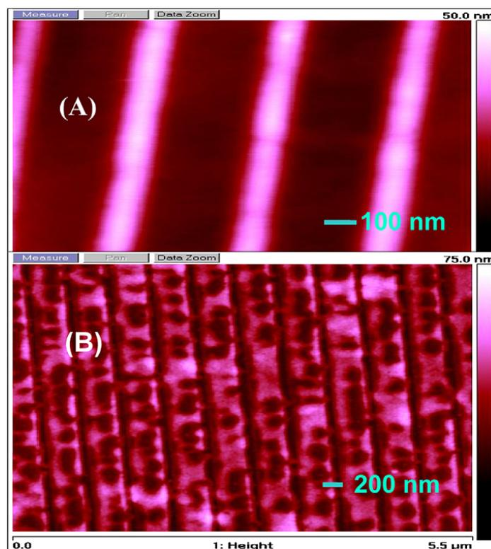
**Figure 2 :** Résolution ultime de  $\mu\text{TM}$  avec une solution de dendrimères. (A) Image AFM des motifs du timbre, la largeur des lignes est de 40 nm. (B) Image AFM du résultat du  $\mu\text{TM}$  de motifs de dendrimères sur du silicium, les lignes font 36 nm de large pour un pas de 400 nm.
