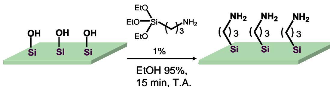
**Figure 16 :** Schéma de la fixation des molécules d'APTES sur une surface de silicium oxydé (pouvant être un wafer de silicium ou une lame de verre). A gauche, le substrat est activé (formation de groupement Si-OH en surface) par un plasma oxygène. Ensuite par phase liquide les molécules d'APTES réagissent avec les groupements activés, formant ainsi des liaisons covalentes.
