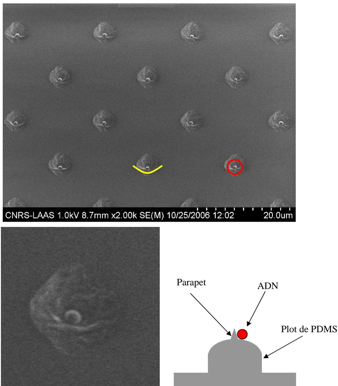
**Figure 20 :** Images MEB d'un peignage d'ADN phage- $\lambda$  sur un timbre de PDMS. Sur l'image du haut nous pouvons remarquer des pelotes d'ADN (repéré par un cercle rouge) prises au piège par le parapet (repéré par l'arc de cercle jaune) sur chacun des motifs de PDMS et uniquement en ces endroits. L'image du bas à gauche nous montre un zoom sur un des motifs. Le schéma en bas à droite représente une coupe d'un motif du timbre piégeant une pelote d'ADN.
