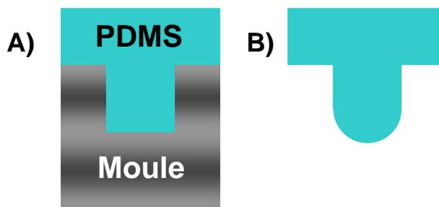
**Figure 17 :** *A) représentation schématique d'un timbre de PDMS réticulant sur un moule. Les structures sur le moules sont à angle droit. B) Le timbre est réticulé puis démoulé, les arêtes des structures sont arrondies.*
