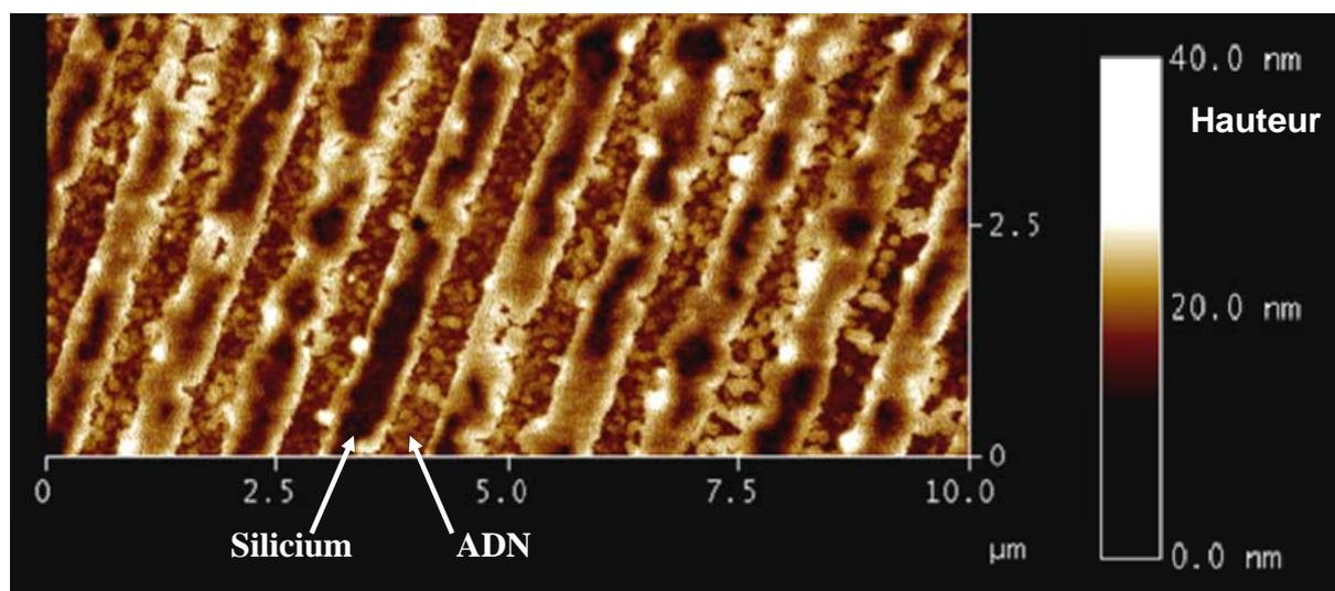
**Figure 9 :** Image AFM d'un dépôt d'ADN suivant un réseau de lignes de 500nm de largeur au pas de 1μm et de quelques manomètres d'épaisseurs. Le dépôt a été effectué sur une lame de verre d'où une rugosité importante.
