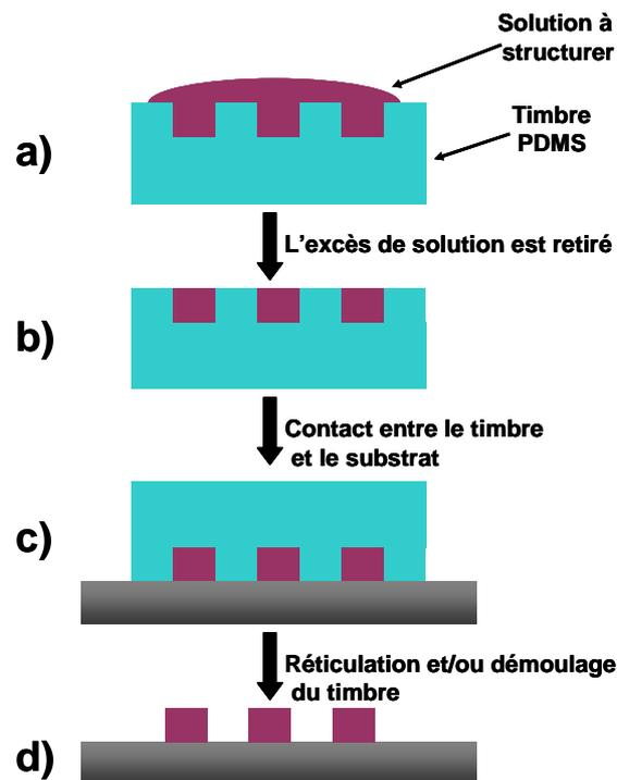
**Figure 11 :** Principe du  $\mu$ TM. a) La solution à structurer est déposée sur le timbre, b) L'excès de solution est retiré du timbre soit par un flux d'azote qui chasse la goutte du timbre soit en « raclant » la surface du timbre à l'aide d'un timbre de PDMS plat. c) Le timbre est ensuite amené en contact avec le substrat, la solution est réticulée si besoin et le timbre est retiré laissant la solution structurée sur le substrat.
