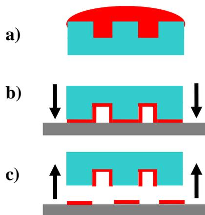
**Figure 14 :** *Principe du contact printing. a) encrage du timbre : une goutte de solution à transférer est déposée sur la face structurée du timbre. Le timbre encré est emmené en contact avec le substrat, c) les molécules encrées sur le timbre sont déposées sur le substrat.*
