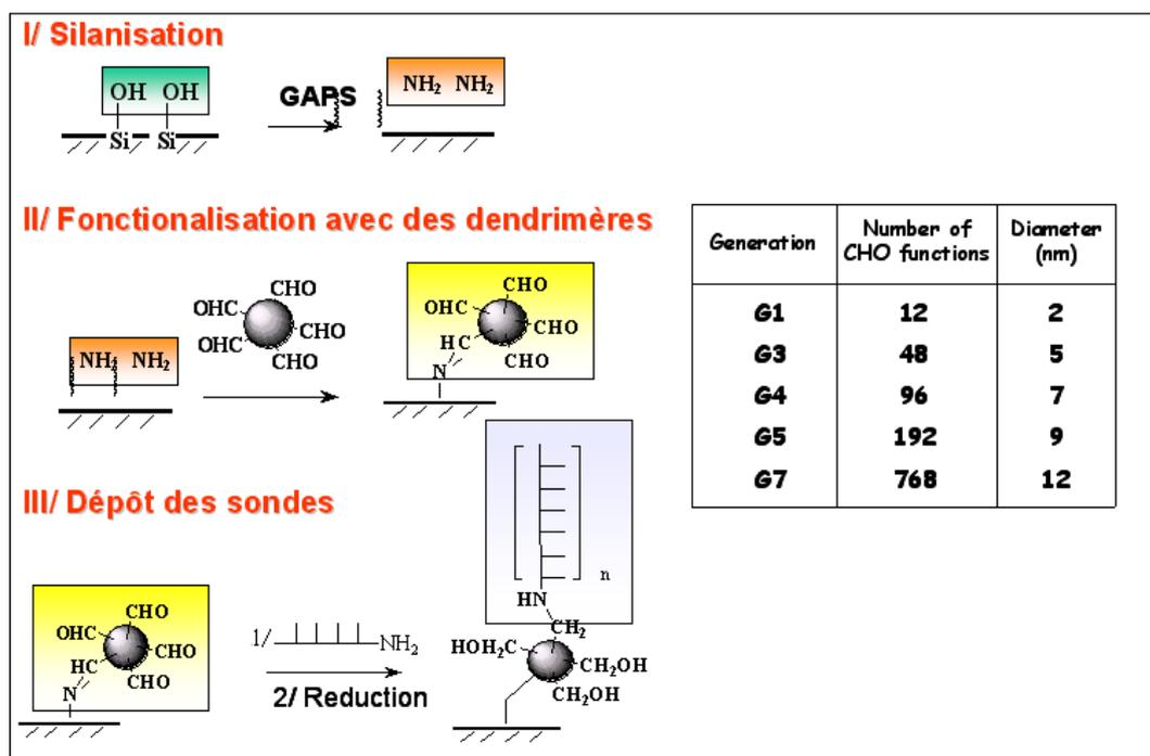
**Figure 19 :** Principe de fonctionnalisation d'une Dendrilame. I) Silanisation de la lame de verre avec un silane amine. II) Deuxième étape de fonctionnalisation, greffage des dendrimères aldéhydes. III) Dépôt des sondes aminées (spotter), puis réduction chimique de la lame pour empêcher les autres sites d'accroches de réagir pendant les étapes d'hybridations.
