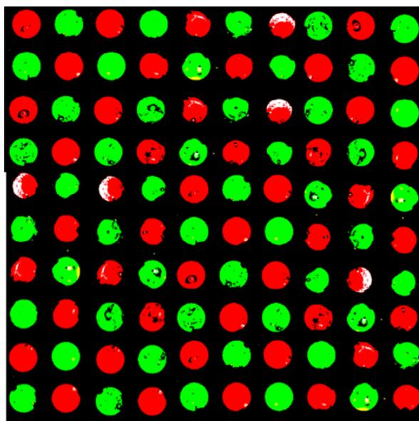
**Figure 18 :** Image en fluorescences de fluorophores déposés sur une lame de verre en utilisant un macrotimbre de PDMS. Test de contamination croisé avec 1 minute d'encrage du timbre dans la plaque de titration, séchage sous un flux d'azote et 15 s de contact avec le substrat. La plaque de titration est remplie avec une alternance puits par puits de fluorophores rouge et vert. La bonne fidélité des couleurs du dépôt certifie une absence de contamination entre les protubérances adjacentes.
