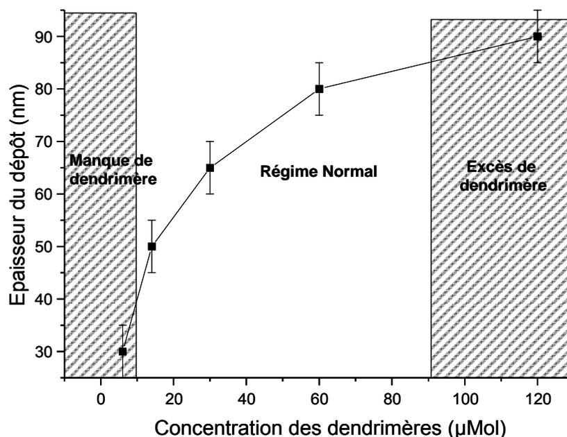
**Figure 4 :** Epaisseur du dépôt en fonction de la concentration en dendrimères. En-dessous de  $10\mu\text{Mol}$ , les motifs deviennent non-uniformes. Le manque de dendrimère engendre un régime de déficit. Au-dessus de  $60\mu\text{Mol}$  nous entrons dans un régime d'excès de concentration de dendrimères. Courbe obtenue pour un timbre dont la profondeur des motifs est de  $90\text{nm}$ .
