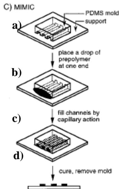
**Figure 10 :** Principe de fonctionnement du MIMIC; a) un timbre (ou moule suivant les dénominations) souple en PDMS est déposé sur le substrat à structurer, b) une goutte de la solution du matériau structurant est déposée à l'entrée des canaux fluidique formé par le timbre. c) Les canaux se remplissent par capillarité, la réticulation est activée et le timbre est retiré lorsqu' elle a eu lieu [18].
