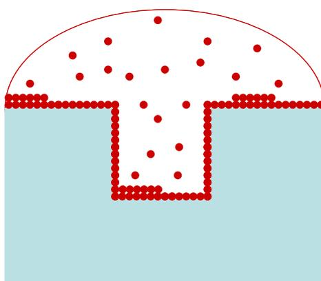
**Figure 4 :** Schématisation du processus d'encrage des molécules de nature « biologique » dans des solvants protiques sur un timbre structuré en PDMS. Les points rouges représentent les molécules biologiques de l'encre. Elles s'adsorbent de façon homogène sur la totalité de la surface du timbre formant une ou plusieurs couches.
