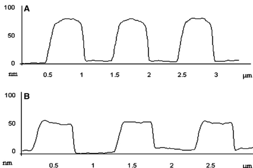
**Figure 3 :** *Mesure AFM de lignes de dendrimères de 500 nm de largeur, obtenues par  $\mu$ TM sur un wafer de silicium fonctionnalisé avec de l'APTES : (a) solution concentrée : 60  $\mu$ M et (b) quatre fois plus faible : 15  $\mu$ M. La profondeur des motifs sur le timbre est de 90 nm.*
