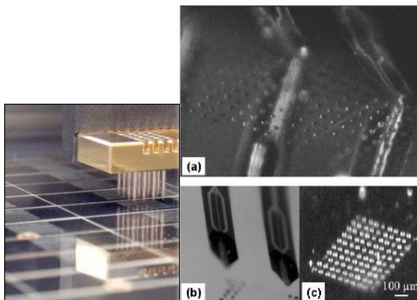
**Figure 13 :** Différents types de spotter. A gauche : spotter classique avec des aiguilles métalliques de quelques centaines de micron au niveau de la pointe permettant le dépôt de gouttes de quelques centaines de micron sur des lames de verre. A droite Spotter développé par le LAAS-CNRS: a) et b) micro leviers en silicium (500 µm de large et une pointe de quelques dizaines de microns permettant le dépôt de gouttes de quelques microns sur des lames de verre c).
