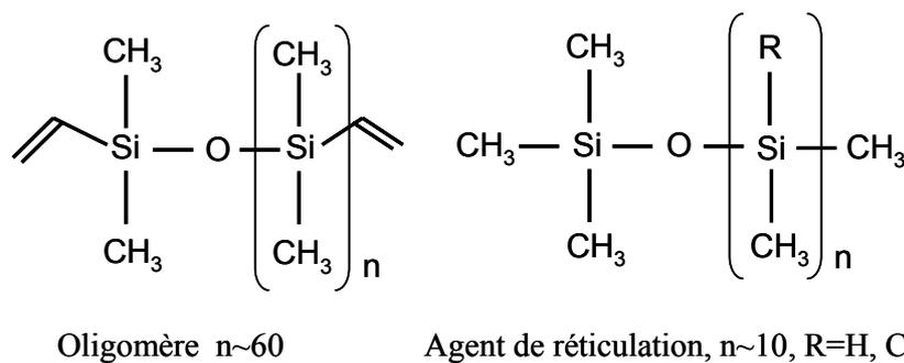
**Figure 3 :** Représentation schématique des deux composants du Sylgard 184®.
