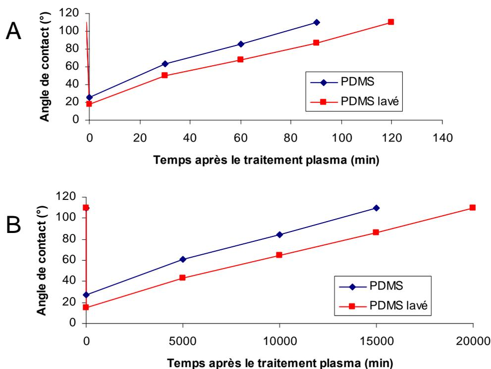
**Figure 1 :** Évolution dans le temps de l'angle de contact eau/PDMS après traitement par plasma oxygène pour deux conditions de stockage : dans l'air (A) et dans l'eau (B). Des timbres non nettoyés de PDMS Sylgard® sont comparés à des timbres semblables nettoyés à l'aide d'un Soxhlet (voir chapitre 2).
