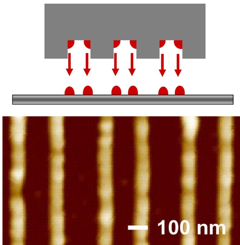
**Figure 6 :** Schéma et image AFM d'un dépôt de bord de dendrimères avec une concentration de  $6 \mu\text{Mol}$ . Le timbre utilisé dans cette expérience est le même que pour les figures précédentes (lignes de  $500 \text{ nm}$  au pas de  $500 \text{ nm}$ ). Seuls les bords des motifs du timbre sont transférés ayant pour résultat des lignes larges de  $100 \text{ nm}$  et d'une épaisseur de  $30 \text{ nm}$ .
