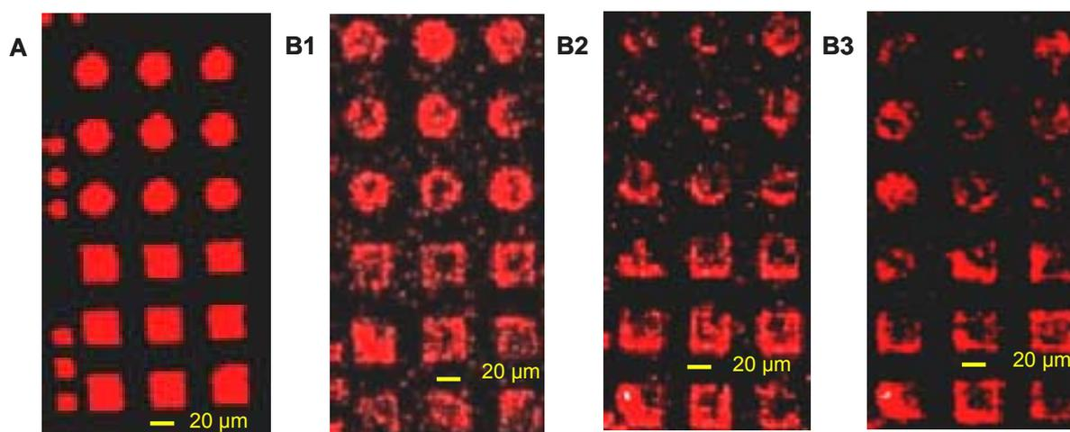
**Figure 13 :** (A) Image en fluorescence du premier dépôt, et (B) montre les dépôts numéros 5 (B1), 6 (B2) et 7(B3). Un timbre a été encré avec une solution d'oligonucléotide 10µMol de 15-mer 5'-Cy5 pendant 30 sec puis a été placé en contact pendant 2 minutes avec une dendrilame et ce 10 fois consécutivement en des positions différentes de la lame.
