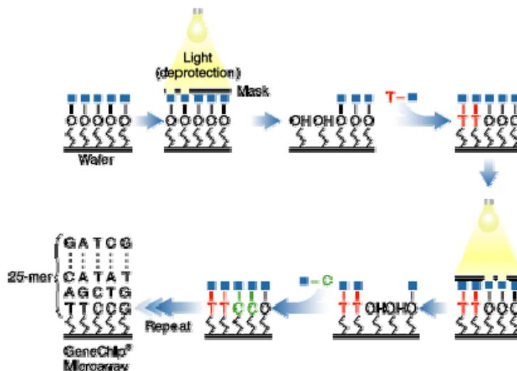
**Figure 20 :** Les sondes sont synthétisées in situ par photolithographie. Au départ, tous les sites sont protégés par un groupement photosensible. L'illumination au travers d'un masque déprotège des plots spécifiques. On peut alors procéder au greffage d'une première base protégée. Le procédé est réitéré avec les bases jusqu'à la synthèse complète des ADN sondes.
