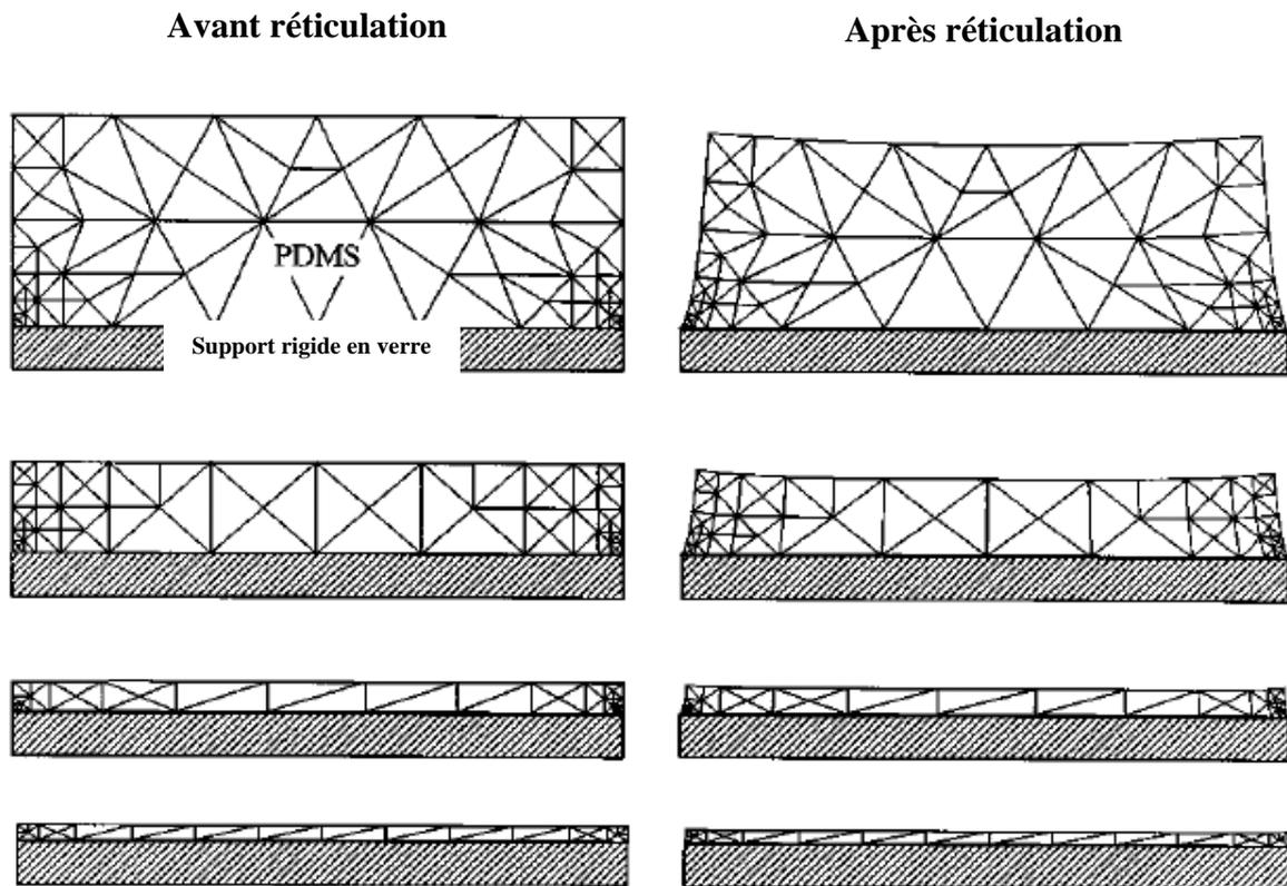
**Figure 18 :** Simulation du retrait thermochimique en fonction de l'épaisseur du timbre, avant et après réticulation. La partie gauche représente un timbre en PDMS déposé sur un support rigide en verre. Nous pouvons noter qu'aucune déformation n'est présente quelle que soit l'épaisseur du timbre. La partie droite représente le même timbre après réticulation. Nous pouvons constater que la déformation diminue avec la diminution en épaisseur du timbre.
