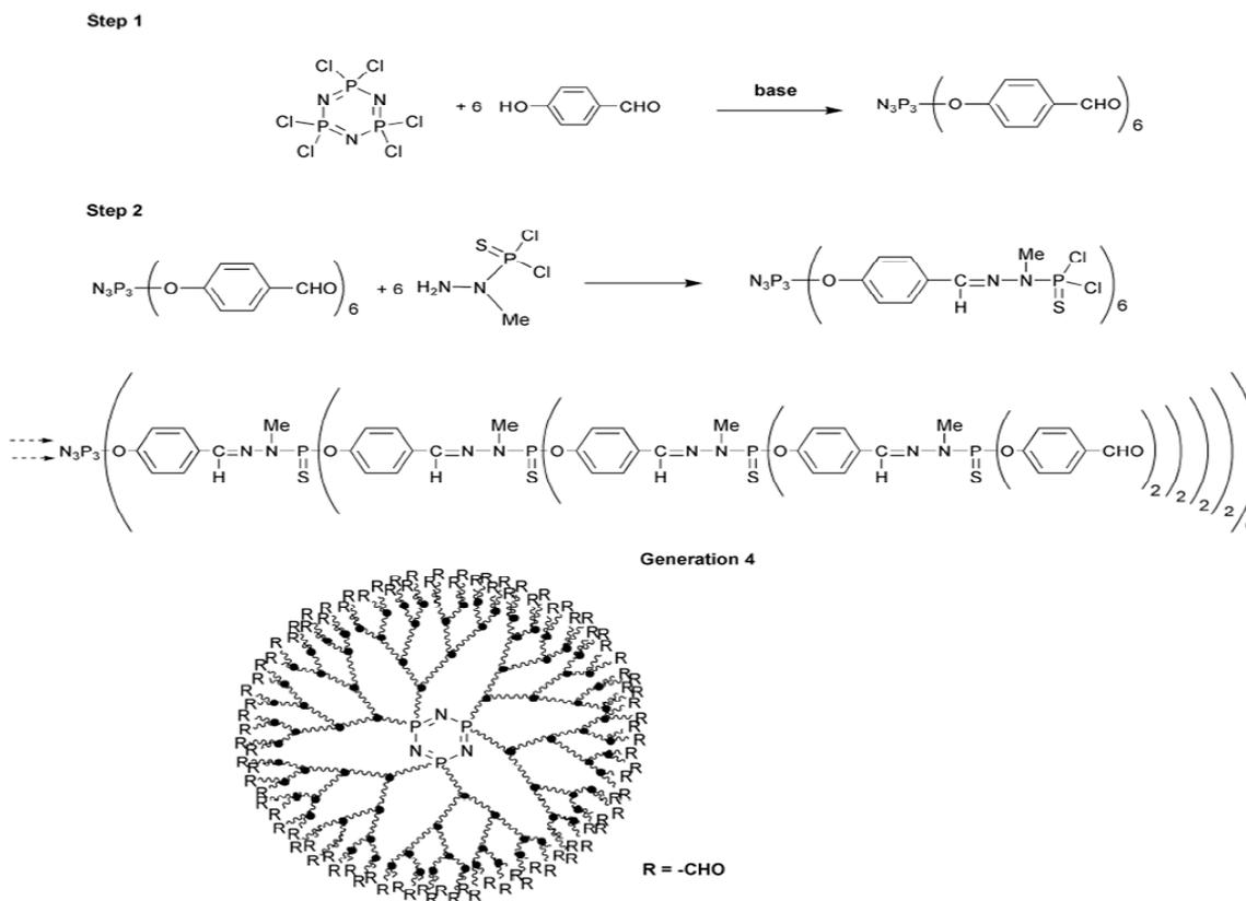
**Figure 17 :** Schéma de croissance des dendrimères phosphorés jusqu'à la génération 4. Le dendrimère possède finalement 96 groupes aldéhydes terminaux et mesure 7 nm de diamètre en solution.
