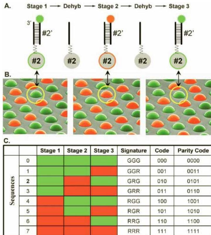
**Figure 24 :** Décodage d'une puce Illumina. Dans cet exemple 3 marqueurs (oligonucléotides) différents ont été greffé sur les billes. Comme l'auto-assemblage est aléatoire, il faut retrouver l'emplacement de chaque oligonucléotide (bille), 3 étapes d'hybridation puis de déshybridation sont utilisées pour coder avec des marqueurs fluorescents la position des billes.
