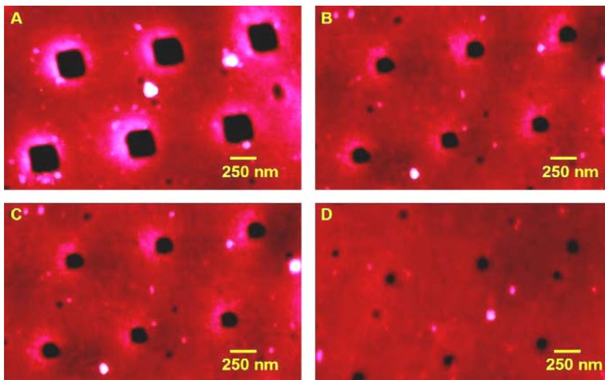
**Figure 8 :** Images d'AFM de  $\mu\text{TM}$  d'un film de dendrimères en régime normal. Tous les motifs ont un espacement de  $1\ \mu\text{m}$  (a) carrés de  $250\text{nm}$ , (b) carrés de  $100\ \text{nm}$ , (c) carrés de  $80\ \text{nm}$  et (d) carrés de  $50\ \text{nm}$ . L'épaisseur du film varie de  $80\ \text{nm}$  à  $50\ \text{nm}$  respectivement pour les images de A et D. Les zones noires sont les trous et les parties roses les dendrimères.
