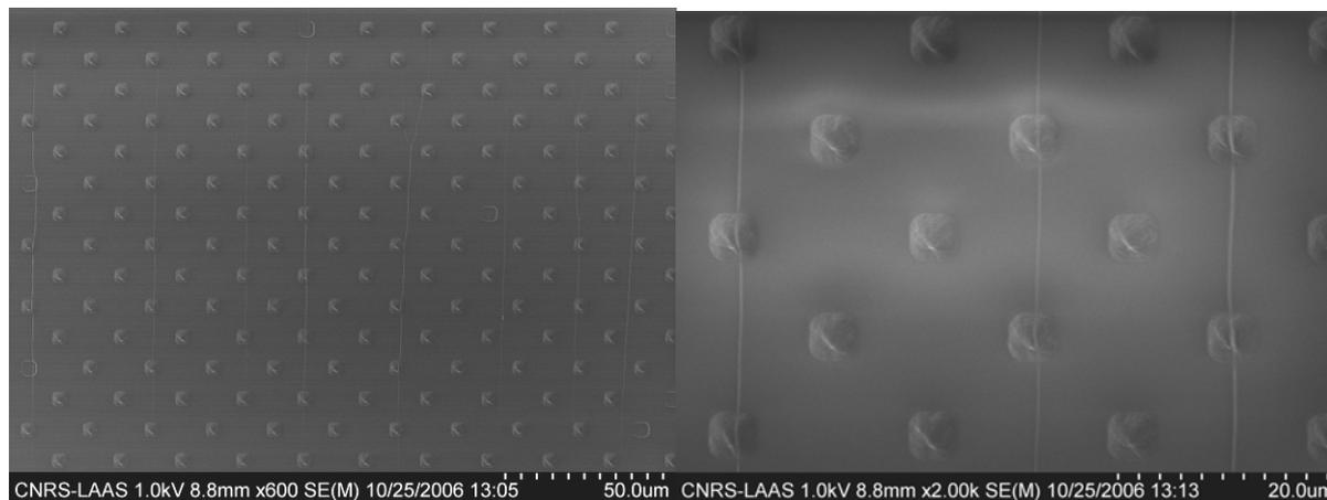
**Figure 21 :** Images MEB d'un peignage d'ADN phage- $\lambda$  sur un timbre de PDMS. Le réseau de motifs avec le parapet a été orienté à  $45^\circ$ . Les brins d'ADN se fixent sur les motifs de PDMS et s'étirent dans la direction de propagation du ménisque de peignage.
