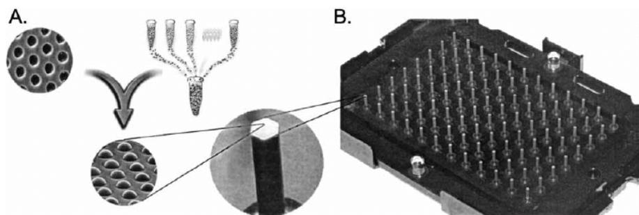
**Figure 23 :** Puce Illumina. A. Puits et solution contenant les billes fonctionnalisées, ces dernières sont auto-assemblées dans les puits sur chaque fibre optique. B. Vue d’ensemble d’une puce Illumina avec 96 fibres optiques.
