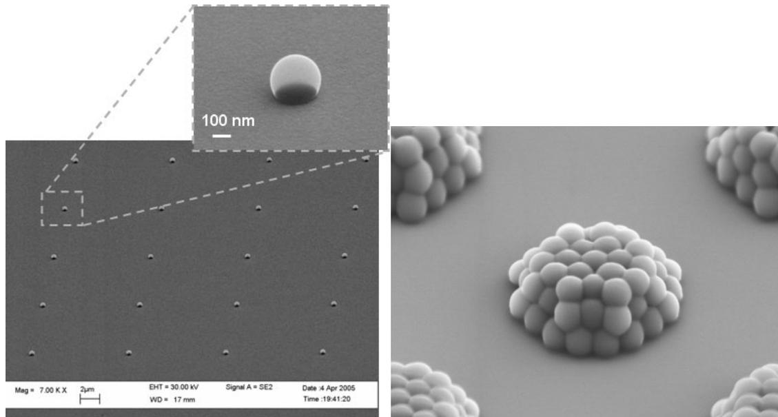
**Figure 3 :** Exemple de couplage entre la lithographie douce et l'auto-assemblage dirigé par capillarité. A gauche, particules isolées de polystyrène d'un diamètre de 500 nm assemblées en réseau sur un timbre en PDMS puis déposées par Microcontact printing sur un substrat de silicium. A droite, particules isolées de polystyrène d'un diamètre de 500 nm assemblées en réseau 3D sur un timbre en PDMS puis déposées par  $\mu$ CP sur un substrat de silicium [3].
