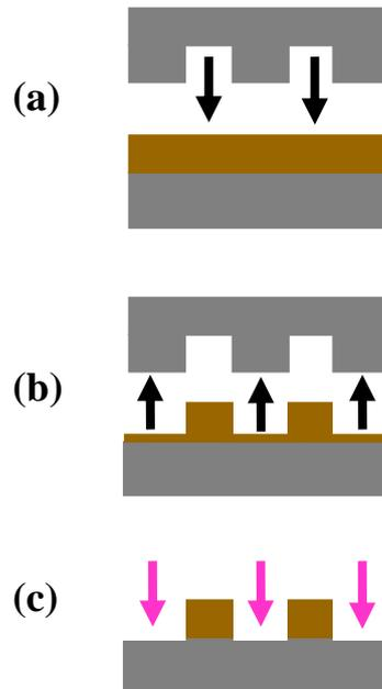
**Figure 9 :** Schéma de principe de la nano-impression. Les étapes illustrées sont : (a) Chauffage du moule et de l'échantillon ou seulement de l'échantillon à  $T > T_g$  et contact entre le moule et l'échantillon avec application d'une pression uniforme (b) Refroidissement et séparation du moule et de l'échantillon à  $T < T_g$  (c) Gravure ionique réactive pour retirer la couche de résine résiduelle suivie d'un éventuel lift-off pour obtenir un masque métallique.
