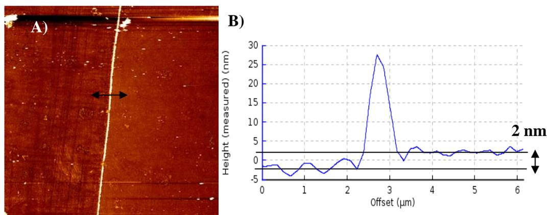
**Figure 6 :** A) Image AFM d'un substrat de verre. La partie située à gauche de la double flèche noir est non contaminée par les résidus de PDMS (Sylgard 184®), la partie à droite est elle contaminée. L'image B) est une section de la zone marqué par une double flèche noir sur de l'image A).
