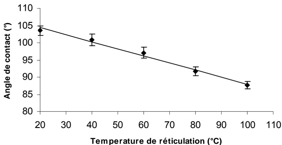
**Figure 9 :** *Dépendance de l'angle de contact eau-substrat (substrat de verre) après impression d'un timbre plat de PDMS (temps de contact : 1 minute) en fonction de la température de réticulation du PDMS. Les barres d'erreur correspondent à différentes mesures combinées avec l'incertitude de mesure d'angle, la ligne est juste un guide pour les yeux.*
