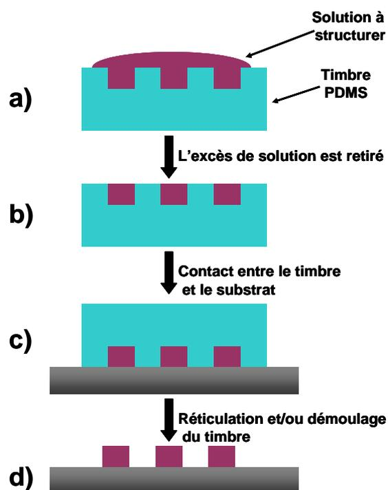
**Figure 1 :** Principe général du Microtransfer Molding ( $\mu\text{TM}$ ). a) La solution à structurer est déposée sur le timbre, b) L'excès de solution est retiré du timbre soit par un flux d'azote qui chasse la goutte du timbre soit en « raclant » la surface du timbre à l'aide d'un timbre de PDMS plat. c) Le timbre est ensuite amené en contact avec le substrat, la solution est réticulée si besoin et le timbre est retiré laissant des structures épaisses sur le substrat.
