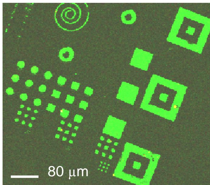
**Figure 11 :** Image en fluorescence d'un dépôt par  $\mu$ CP de thiols carboxyle sur de l'or. Un peptide fluorescent est greffé sur le thiol par phase liquide. Le bruit de fond important est dû aux fixations non spécifiques des peptides sur la surface d'or.
