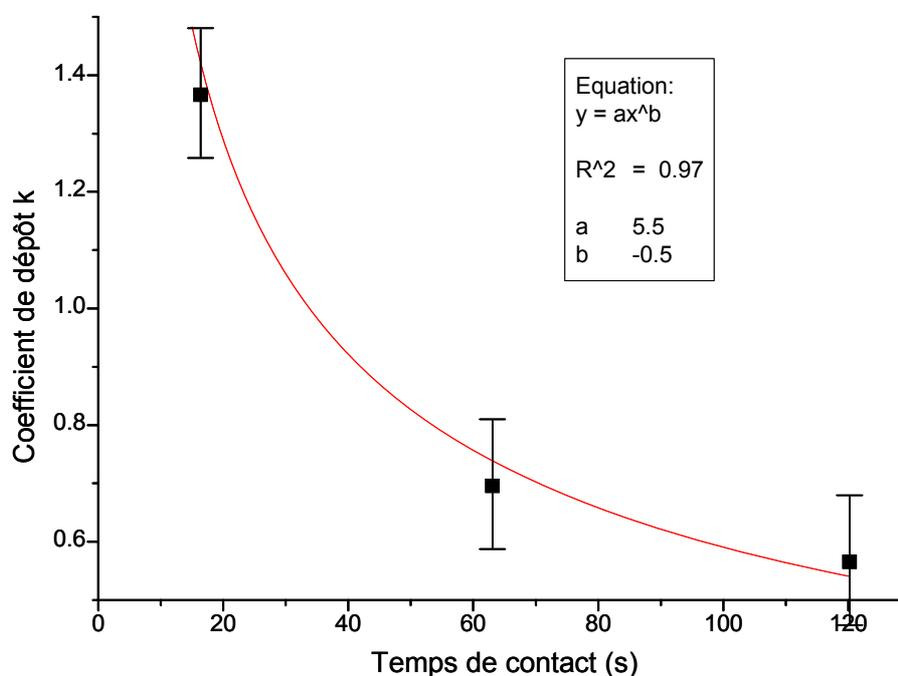
**Figure 11 :** Evolution du coefficient de dépôt  $k$  en fonction du temps de contact. La courbe en rouge correspond à un ajustement effectué sur les données expérimentales avec une bonne correspondance ( $R^2=0,97$ ). L'équation en résultant est la suivante :  $k = 5,5 \frac{1}{\sqrt{x}}$ .
