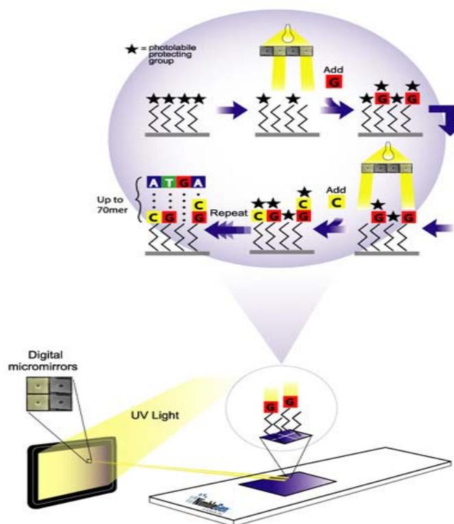
**Figure 21 :** Les sondes sont synthétisées *in situ* par photolithographie. Au départ, tous les sites sont protégés par un groupement photosensible. L’illumination au travers d’un masque déprotège des plots spécifiques. Dans ce cas l’intelligence du système réside dans le masque qui est un miroir digital. On peut alors procéder au greffage d’une première base protégée. Le procédé est réitéré avec les bases jusqu’à la synthèse complète des ADN sondes.
