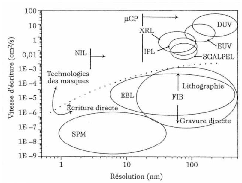
**Figure 1 :** Graphique représentant un panel des différentes technologies de lithographie en fonction de leur couple résolution / vitesse d'écriture. Acronymes : SPM (Scanning Probe Microscope), EBL (Electron Beam Lithography), FIB (Focused Ion Beam), NIL (Nano Imprint Lithography),  $\mu$ CP (Micro-Contact Printing), XRL (X Ray Lithography), IPL (Ion Projection Lithography), DUV (Deep UV), EUV (Extreme UV), SCALPEL (Scattering with Angular Limitation. Projection Electron-beam Lithography).
