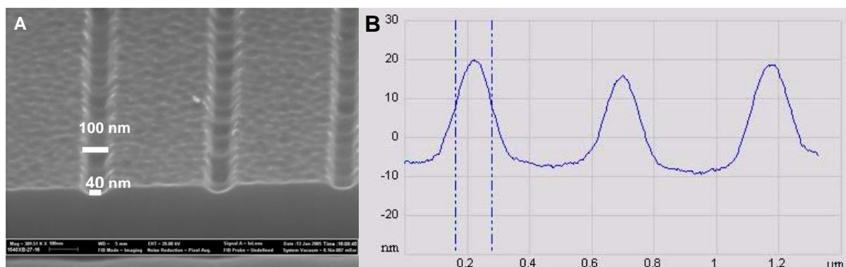
**Figure 1 :** L'image A est une image MEB à 45° d'un moule observé par la tranche grâce à une découpe au FIB. Le fond du motif est large de 40 nm et le sommet de 100 nm avec une profondeur de 25 nm. L'image B est une coupe AFM des motifs du timbre. Les structures mesurées après déconvolution de la pointe montre les mêmes dimensions soit 25 nm de hauteur, 40 nm de largeur au sommet du timbre et 100 nm à la base.
