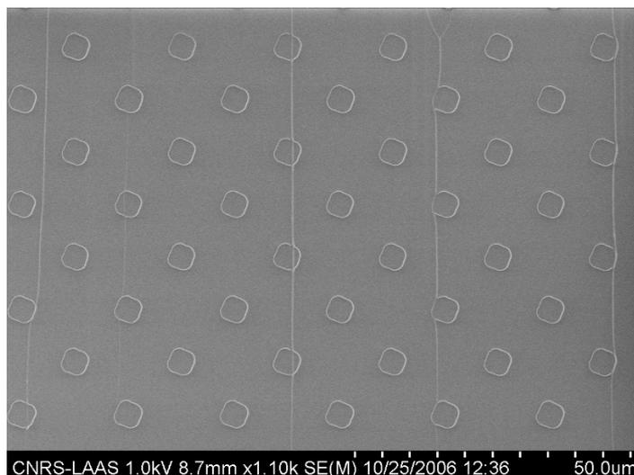
**Figure 22 :** Images MEB d'un peignage d'ADN phage- $\lambda$  sur un timbre de PDMS. Le réseau de motifs carrés sans parapet a été orienté à  $45^\circ$ . Les cordes d'ADN se fixent sur les bords motifs de PDMS et s'étirent dans la direction de propagation du ménisque de peignage.
