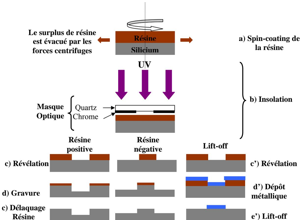
**Figure 5 :** Schéma des étapes de photolithographie. Spin-coating de la résine sur le substrat a), insolation à travers le masque de photolithographie b), révélation chimique des différentes résines (positives ou négatives) c), gravure chimique et/ou physique d) nettoyage de la résine restante. La voie par lift-off comporte quelques différences : révélation chimique des différentes résines (positives ou négatives) c), dépôt métallique d) nettoyage de la résine restante.
