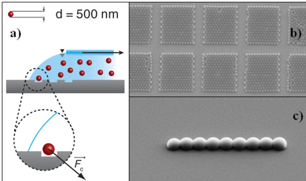
**Figure 2 :** Auto-assemblage de billes de polystyrène de 500nm sur structures topographiques. a) Schéma représentant le phénomène d'assemblage capillaire sur une surface contenant des motifs topographiques. B) image MEB de carrées remplies par un cristal 2D, c) ligne de nanoparticules assemblés [3].
