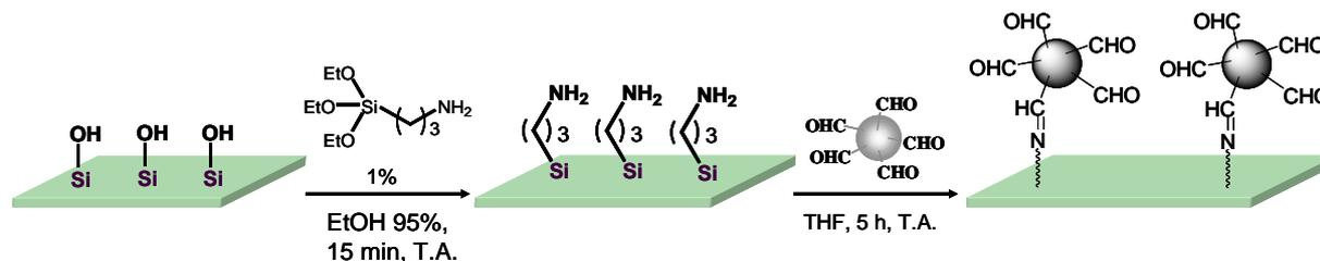
**Figure 18 :** *Processus de fabrication d'une dendrilame. La première étape consiste en la fonctionnalisation d'une lame de verre avec des molécules d'APTES. La deuxième étape permet la fixation par phase liquide des dendrimères par liaisons covalente entre les groupements amines de l'APTES et les groupements aldéhydes des dendrimères.*
