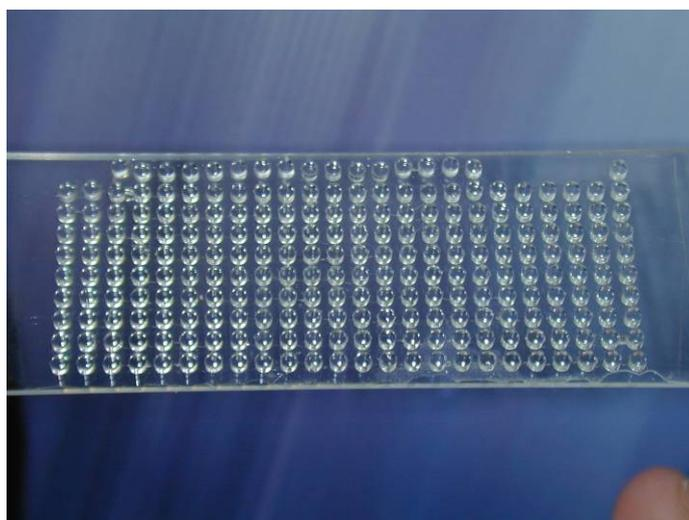
**Figure 17 :** Photographie d'un timbre de PDMS avec des dimensions conformes à une plaque de titration pour le  $\mu\text{CP}$  multiplexé. Ce timbre comporte plus de 200 protubérances agissant toutes comme un timbre indépendant. Chaque protubérance fait moins d' $1\text{ mm}^2$  et possède des motifs micrométriques et/ou nanométriques à sa surface.
