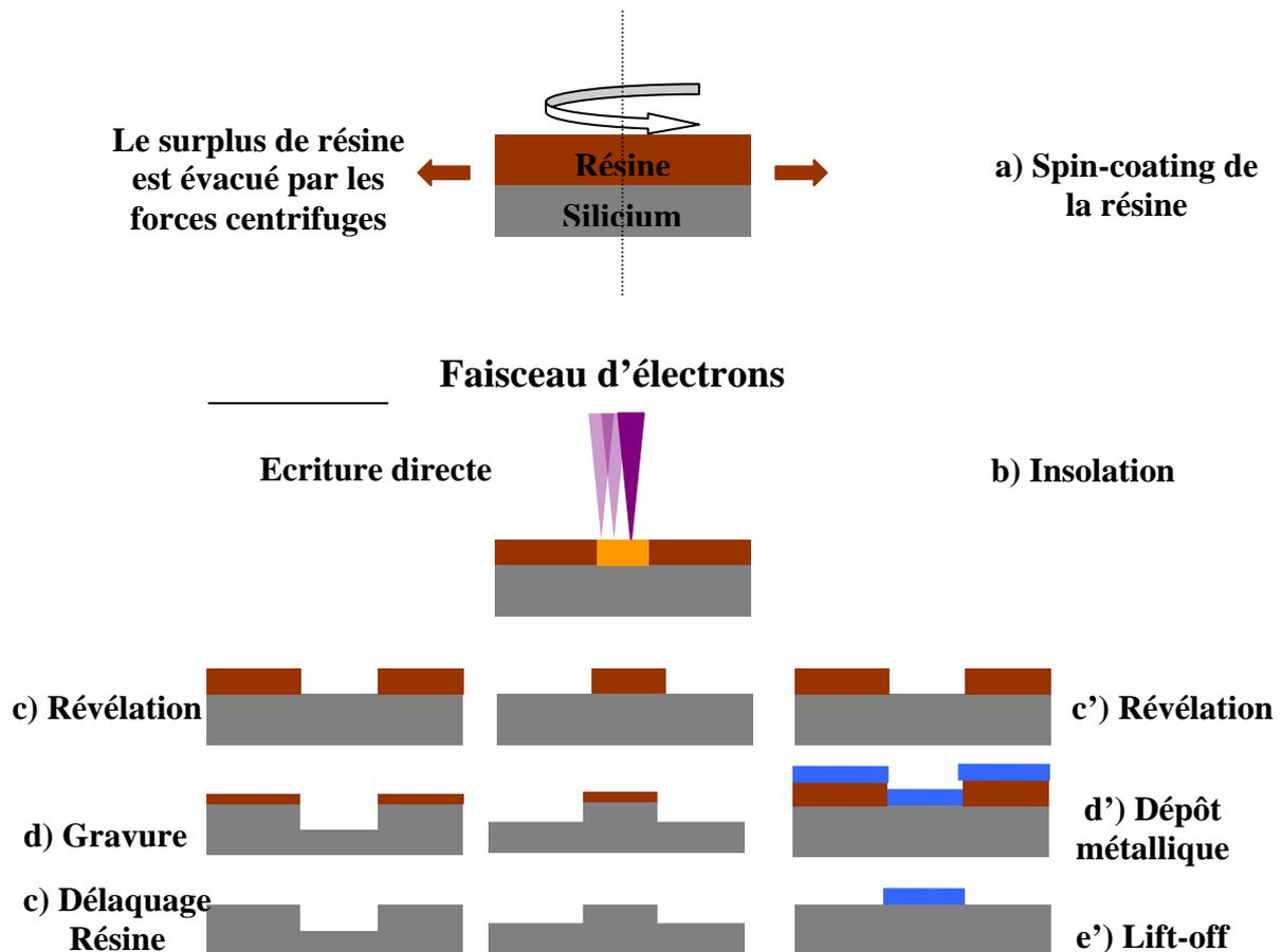
**Figure 6 :** Résumé des étapes de lithographie électronique. Spin-coating de la résine sur le substrat a), insolation par écriture directe sur la résine b), révélation chimique des différentes résines (positives ou négatives) c), gravure chimique et/ou physique d) nettoyage de la résine restante. La voie par lift-off comporte quelques différences : révélation chimique des différentes résines (positives ou négatives) c), dépôt métallique d) nettoyage de la résine restante.
