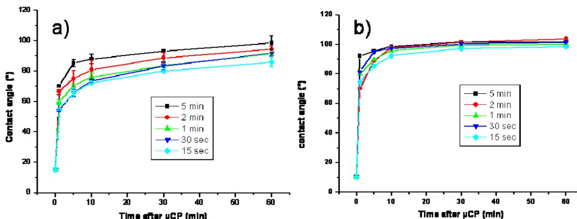
**Figure 10 :** Evolution dans le temps de l'angle de contact eau-substrat (substrat de verre) après impression d'un timbre de PDMS plat. Les différents points expérimentaux correspondent à divers temps de contact : de 15 s à 5 min. La figure a) correspond à un timbre de PDMS en Sylgard 184® réticulé pendant 24 h à 60°C et la figure b) correspond à un timbre de Hard-PDMS réticulé pendant 2 heures à 60°C.
