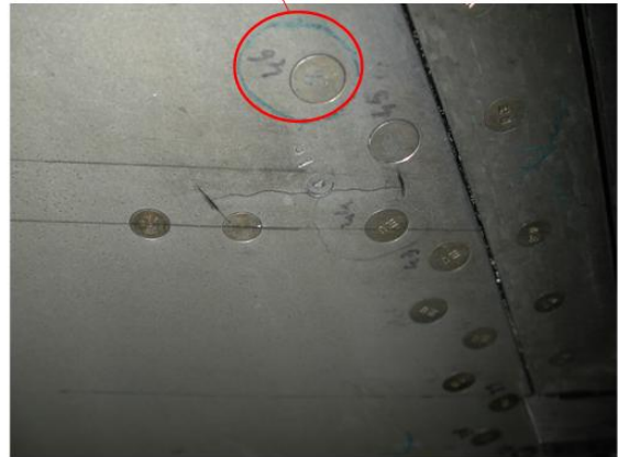
FIG. 1.2.2 – Localisation de la fissure par fatigue de l'Alphajet (AIA).
