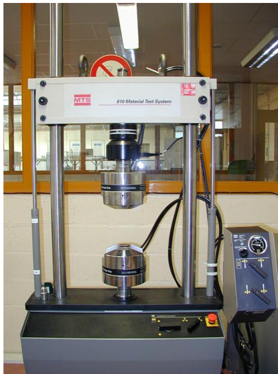
FIG. 1.3.1 – Dispositif expérimental de fatigue.
