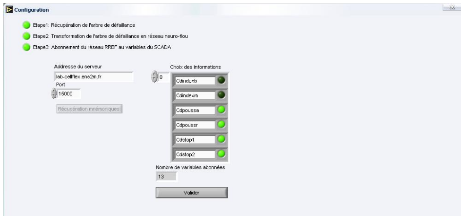
FIG. IV.14 – Capture de LabVIEW : Abonnement du réseau RRF aux variables du SCADA
