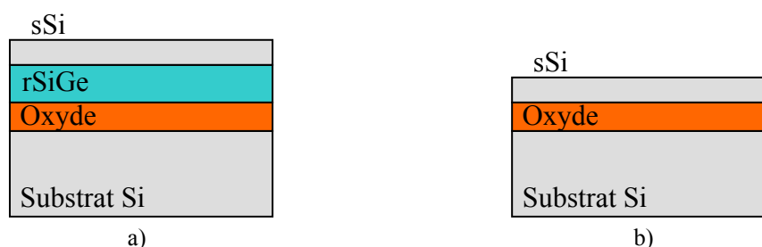
Fig. I.20 : Structures de silicium contraint (a) par procédé SGOI et (b) par procédé sSOI
