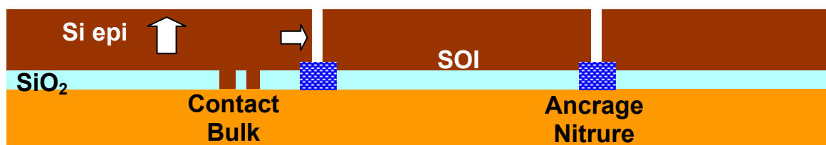
4. Reprise d'épitaxie : croissance verticale, et également latérale au dessus des plots de nitrure
