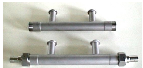
Figure IV- 5 : Module de pervaporation tubulaire
