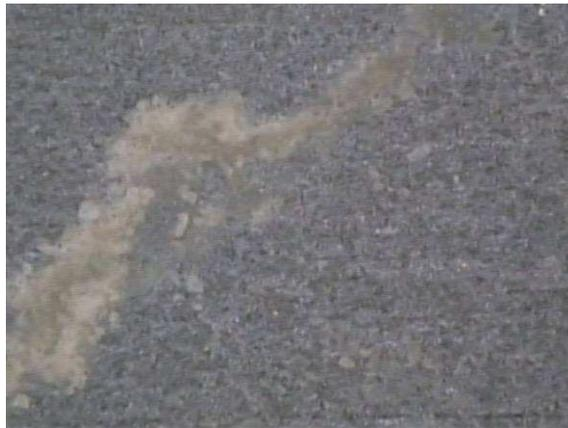
**Figure 4.5 :** Anode d'un condensateur 4700  $\mu$ F, 500 V, après 500 cycles (X200) [1]
