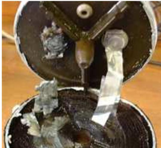
**Figure 4.6 :** Corrosion de l'anode d'un condensateur 4700  $\mu$ F, 500 V [1]
