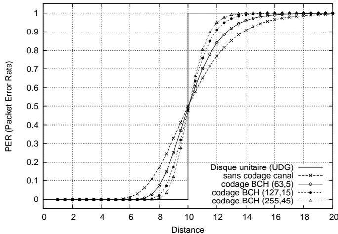
FIG. 5.1 – Probabilité d'échec d'une transmission d'un paquet de 30 bits de données, lorsqu'une modulation BPSK (pour *Binary Phase Shift Keying*) et un canal gaussien avec bruit blanc (AWGN) sont simulés.
