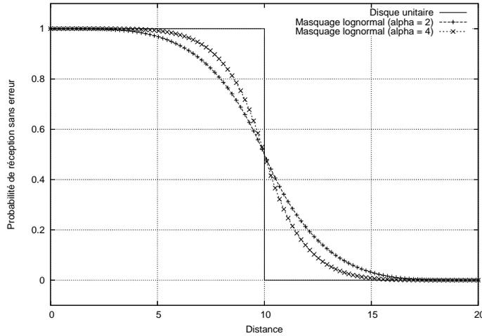
FIG. 5.2 – Les deux modèles physiques considérés ( $CR = 10$ ).
