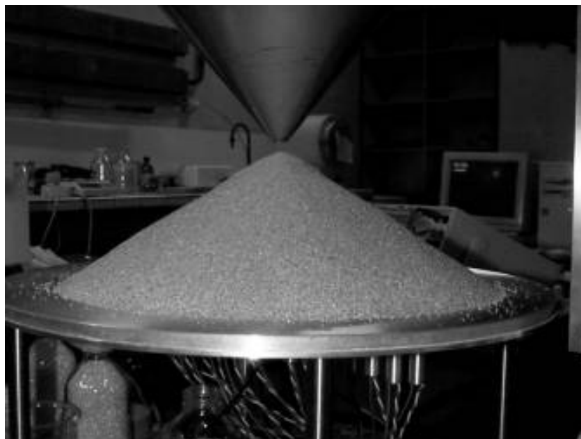
FIG. 3.8: Forme du tas construit en avalanches à partir d'un petit orifice.
