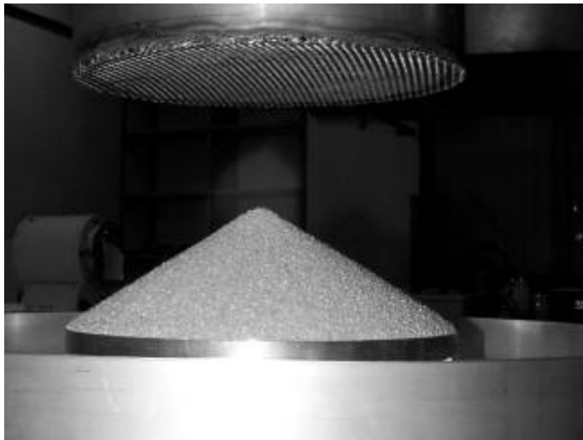
FIG. 3.14: Forme du tas construit par dépot en couches sur un plateau circulaire de diamètre inférieur à celui du tamis.
