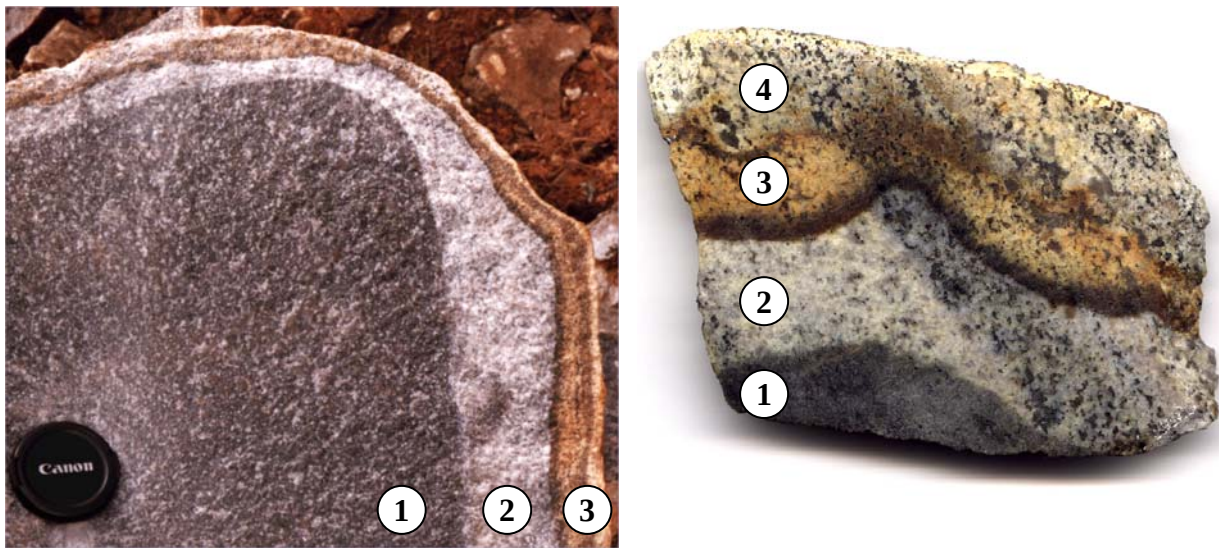
Figure II-2 : Schéma de l'altération de la charnockite (1, noyau sain ; 2 zone hyaline ; 3, zone d'imprégnation ferrugineuse ; 4, cortex périphérique)
