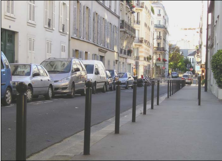
Figure n°38. Préserver les trottoirs du stationnement sauvage : les potelets (rue d'Alembert dans le 14 ème arrondissement de Paris, septembre 2007)
