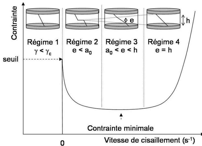
FIG. 4.4 – Détermination des quatre régimes d'écoulement définis par Pignon et al. [117] à partir de la combinaison d'essais rhéométriques (essais d'écoulement en contrainte imposée) et d'observations du champ de déformation pour une suspension de laponite.
