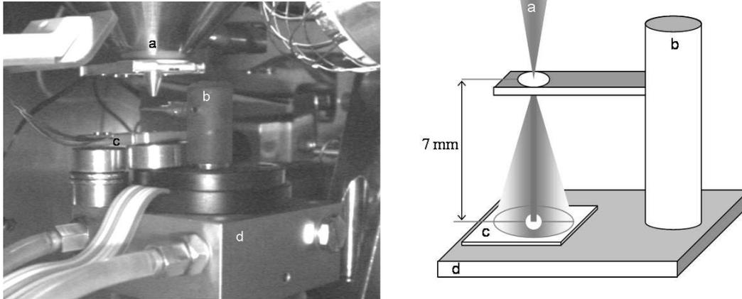
FIG. 1.21 – Schéma et photographie du montage expérimental placé dans la chambre du microscope électronique à transmission afin d’observer les particules en suspension. *a* : faisceau incident d’électrons, *b* : porte échantillon, *c* : collecteur d’électrons, *d* : platine Peltier.
