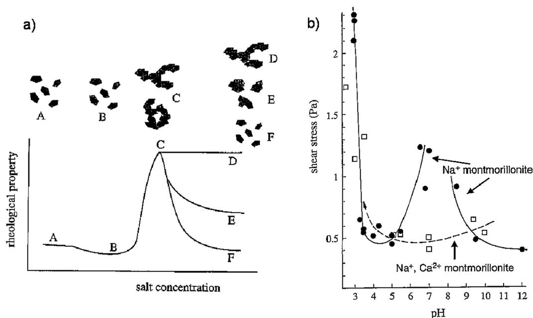
FIG. 1.17 – a/ Influence d'un électrolyte sur le comportement mécanique de suspensions diluées d'argile, selon Lagaly [51]. b/ Evolution de la contrainte ( $94,5 \text{ s}^{-1}$ ) en fonction du pH pour une montmorillonite sodique (●) et la bentonite mère calcique (□), d'après Permien et Lagaly [112].
