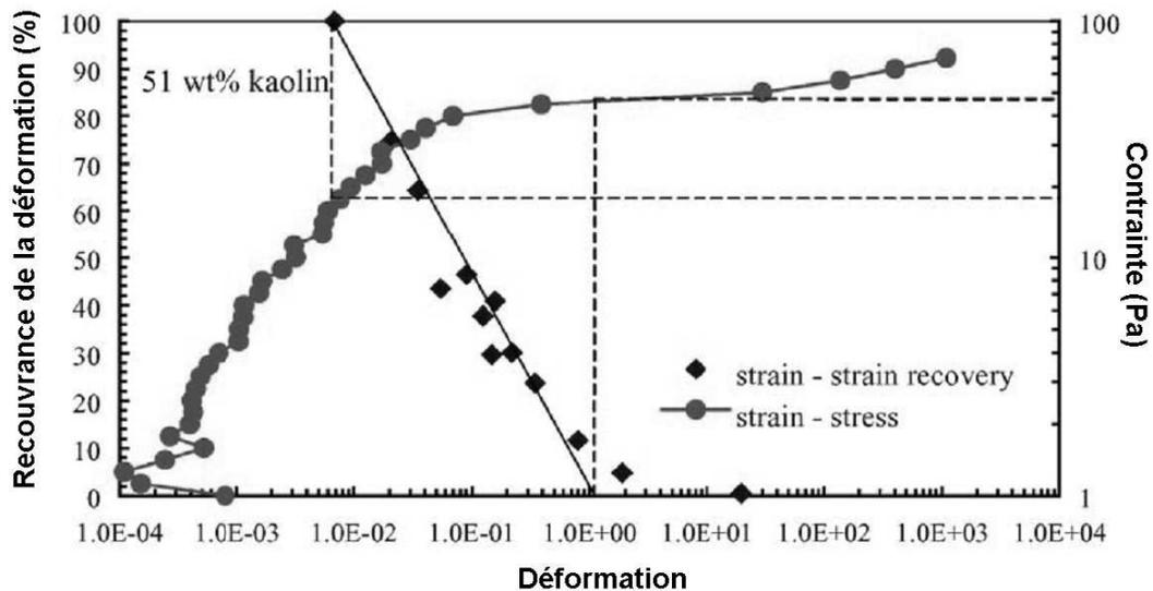
FIG. 4.5 – Détermination de la limite d'élasticité ( $\tau_e$ ) et de la limite de plasticité ( $\tau_p$ ) par Uhlherr *et al.* [139] à partir du taux de recouvrance de la déformation pour des suspensions de kaolin.
