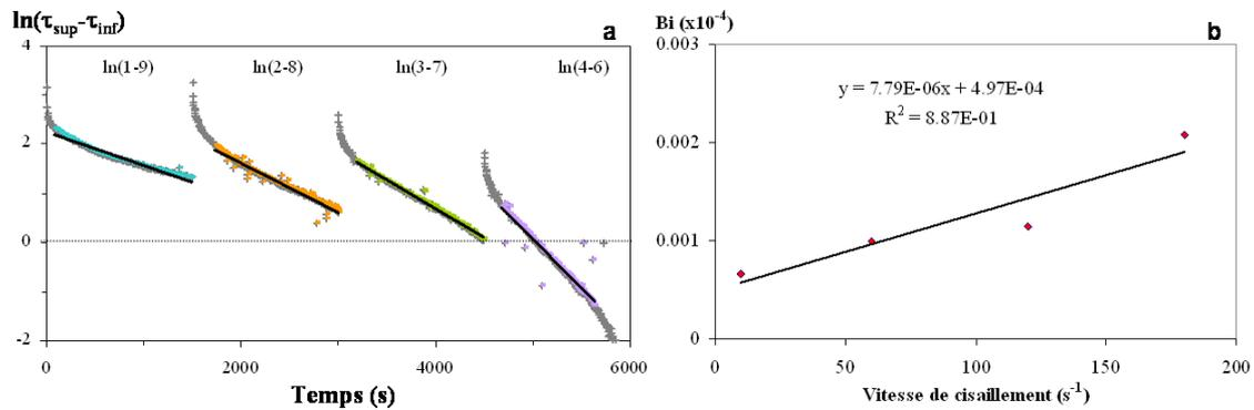
FIG. 4.20 – Exemple de détermination des paramètres du modèle de Mollet pour une suspension à 80 PPS et 100 g/l. a : Portion de palier modélisée. b : Evolution des  $B_i$  en fonction de la vitesse de cisaillement.
