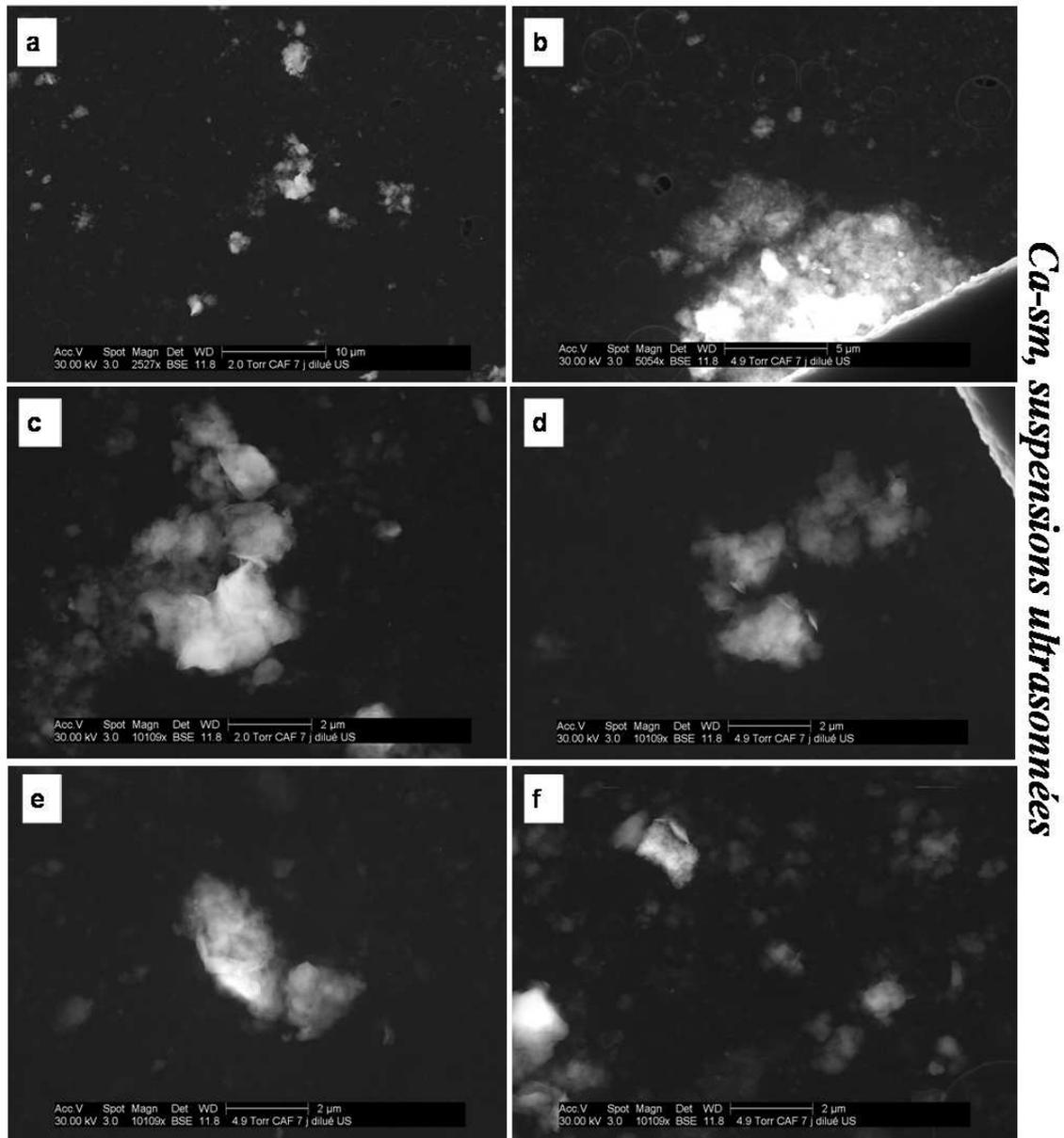
FIG. 3.7 – Images obtenues au Wet STEM sur des suspensions de Ca-sm après traitement aux ultrasons (0,1 g/l)(Photo A. Bogner et G. Thollet).
