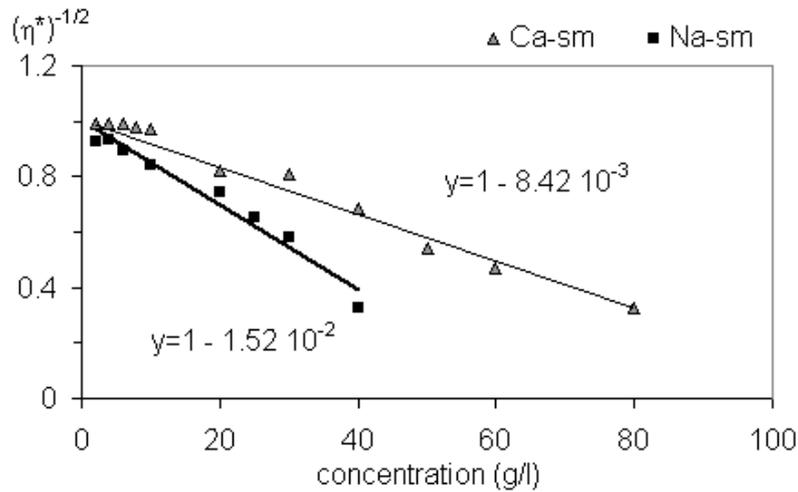
FIG. 3.12 – Détermination du paramètre  $A$  à l'aide de la loi de Krieger–Dougherty .
