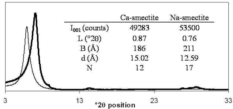
FIG. 2.13 – DRX sur lame orientée de Ca-sm et Na-sm et paramètres liés au pic principal  $d_{001}$  : intensité ( $I_{001}$ (counts)), espacement inter-feuillets  $d$ (Å), distance angulaire à mi-hauteur  $L$ (°2θ), épaisseur  $B$ (Å) et nombre de plans  $N$  dans un ensemble cristallin.
