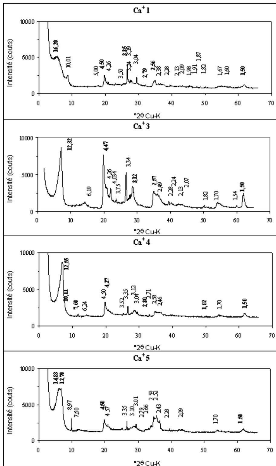
FIG. 13 – Diffractogrammes sur poudres obtenus pour les bentonites calciques activées (1 à 5).
