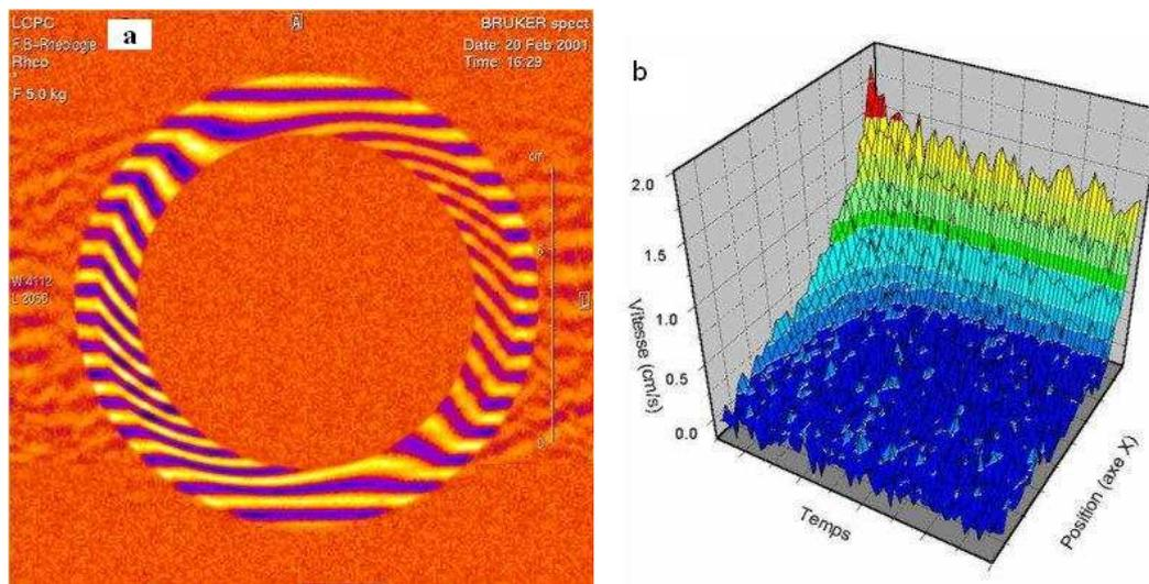
FIG. 1.24 – a : Technique IRM d'imagerie zébrée appliquée à un fluide confiné entre deux cylindres coaxiaux. b : Evolution au cours du temps du profil des vitesses tangentielles au sein d'une géométrie à cylindres coaxiaux pour une laponite suite à l'abaissement brutal de la vitesse de rotation imposée par le cylindre intérieur. D'après Coussot [30].
