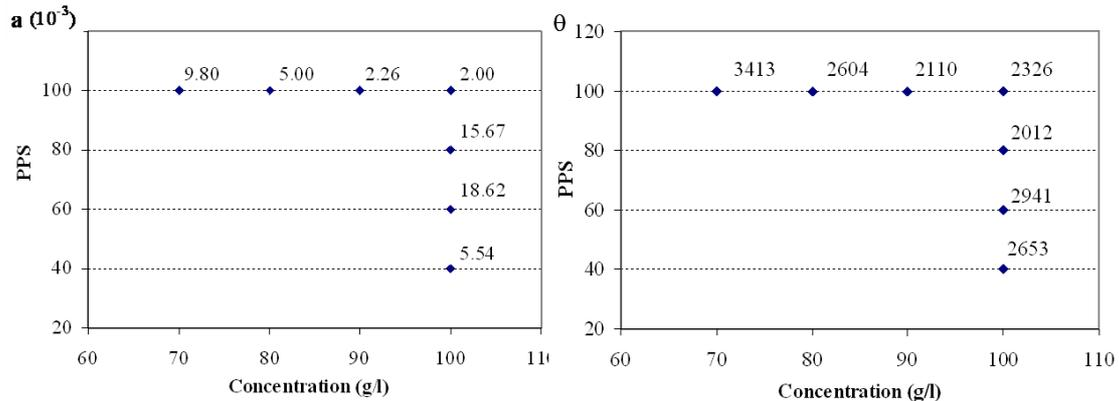
FIG. 4.22 – Paramètres du modèle de Mollet déterminés pour 7 suspensions.
