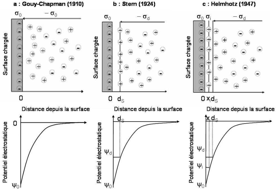
FIG. 1.6 – a : Modèle de Gouy-Chapman montrant l'interface entre une surface chargée de potentiel  $\psi_0$  et une solution électrolytique. b et c : Modèles double couche (Stern) et triple couche (Helmholtz) individualisant le plan interne de Helmholtz (à la distance  $x_i$  de la surface) et le plan externe de Helmholtz, confondu avec le plan de Stern, (à la distance  $d_S$  de la surface) [146].
