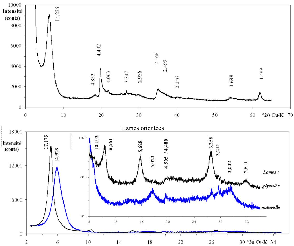
FIG. 2.12 – Diffractogramme aux rayons X de la fraction fine extraite sur poudre désorientée (a) et lame orientée (b) naturelle et glycolée.
