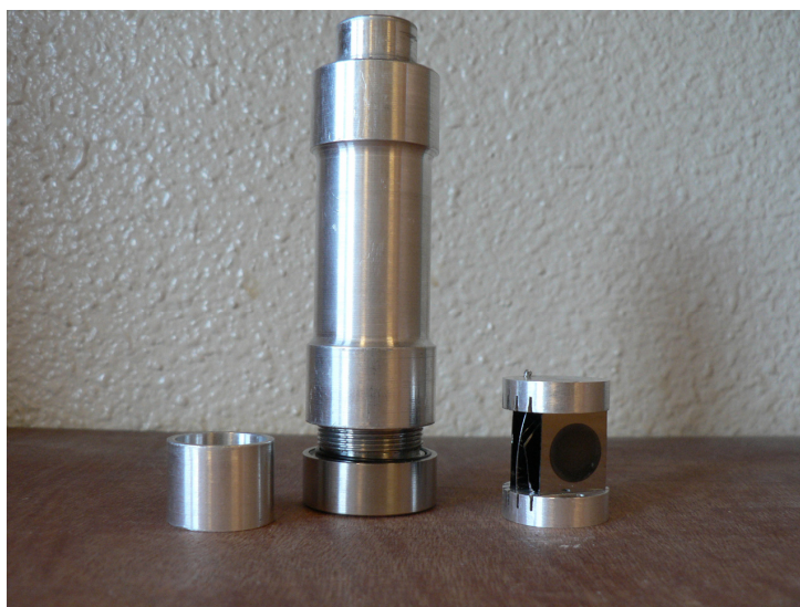
Figure 2.12 : Cellule échantillon utilisée dans le cadre des expériences de diffusion neutronique. Cette cellule en aluminium permet d'accueillir dix plaquettes de silicium poreux et possède une épaisseur de 1mm.
