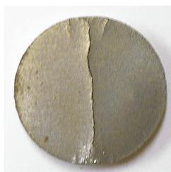
FIG. 2.18 – Rupture d’un échantillon en compression diamétrale.
