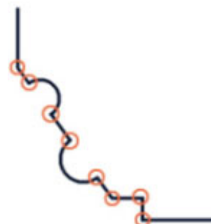
Figure 129 : Points de contrôle d'un profil mouluré
