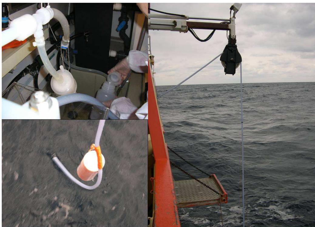
**Figure II.2** : Images de prélèvements d'eau de mer à bord du Théthys II : à gauche en haut, cartouche de filtration sur pompe ; à gauche en bas, lest en Teflon ; à droite, tuyau immergé dans l'eau.
