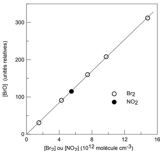
Figure II-4 : exemple de courbe d'étalonnage de BrO
