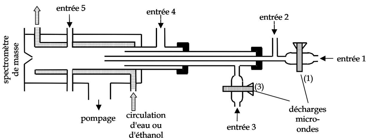
Figure II-1 : réacteur à écoulement et à décharge
