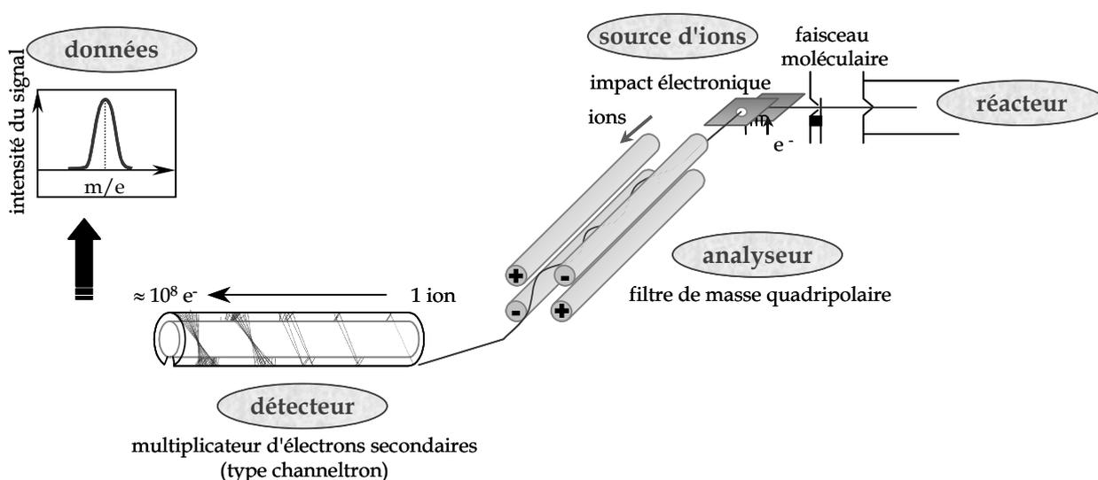
Figure II-2 : principe du spectromètre de masse utilisé
