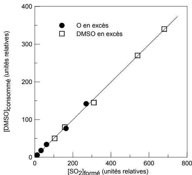
Figure II-6 : exemple de courbe d'étalonnage du DMSO dépendance de [DMSO] consommé en fonction de [SO<sub>2</sub>] formé
