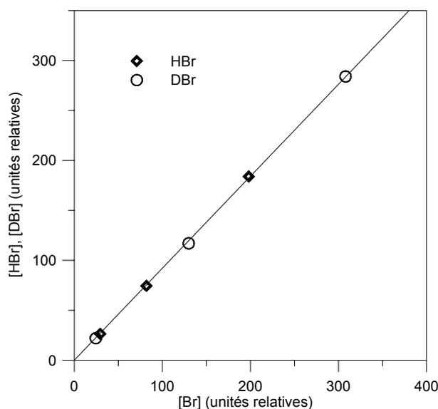
Figure II-5 : exemple de courbe d'étalonnage de HBr et DBr
