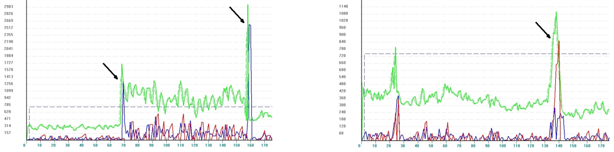
FIG. 2.3 – Evolution temporelle des mesures d (en vert), d' (en rouge), et d'_{\text{cumul}} (en bleu) pour des séquences contenant des transitions brusques (à gauche) ou progressives (à droite) indiquées par les flèches.
