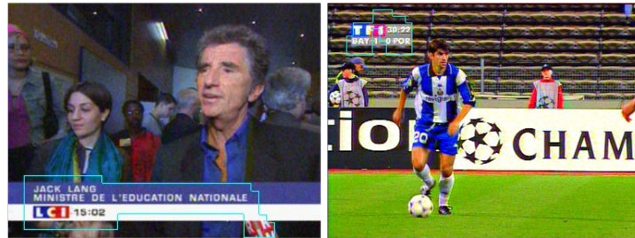
FIG. 8.5 – Extraction du texte incrusté par détection de contours et analyse de l'évolution temporelle des couleurs des pixels.
