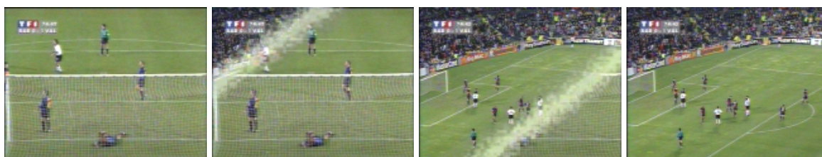
FIG. 1.3 – Exemple d’une transition progressive de type volet.
