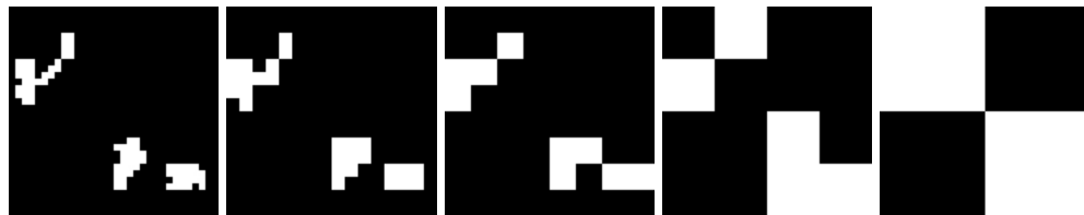
FIG. 3.6 – Représentation d'une image à différentes résolutions, de la résolution originale r = 0 (à gauche) à r = r_{\max} = 5 (à droite).
