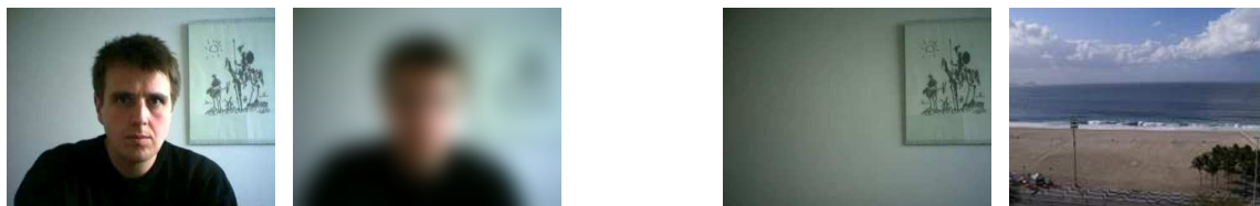
FIG. 2.15: Exemple d'exposition sélective : image capturée, image filtrée, image préenregistrée ambiguë et indicateur explicite d'absence prolongée
