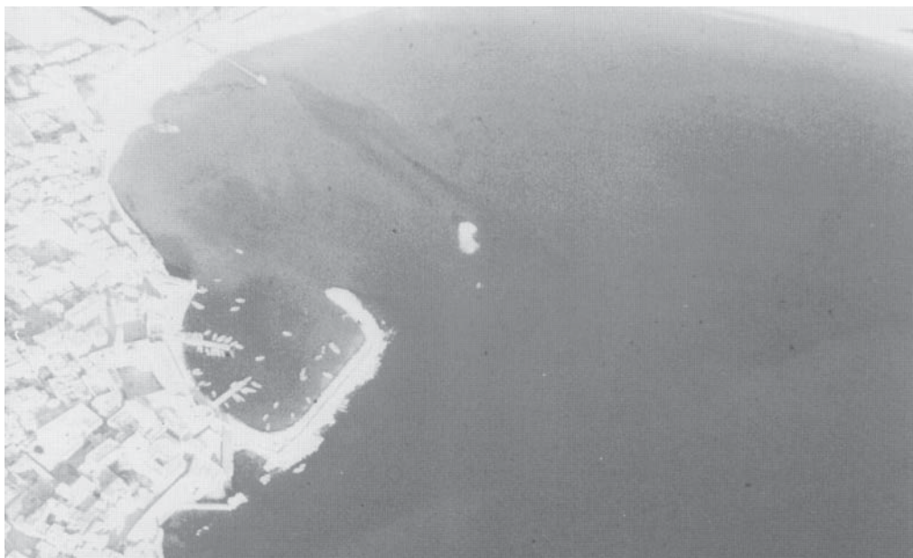
27.03. Vue aérienne oblique depuis l'Ouest du port moderne d'Akko (RABAN, 1995a). On remarque l'île de la Tour des Vents au centre et la trace du brise-lames Est, submergée entre l'île et le continent.
