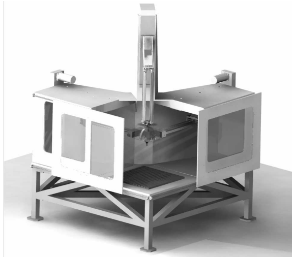
Figure 91 : Prototype CAO de l'Orthoglide 5 axes réalisé par Symétrie pour l'IRCCyN
