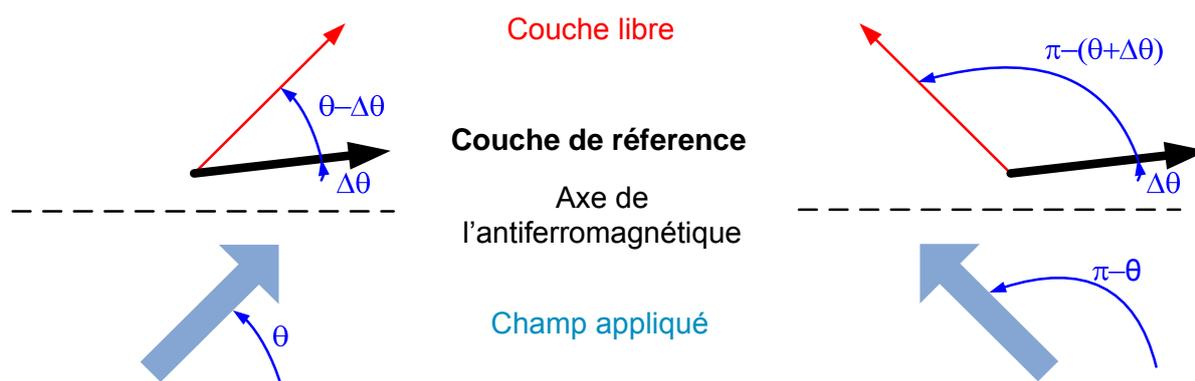
**Figure. 4.13** – Effet de la rotation de la couche de référence sur l'angle relatif entre les aimantations de la couche libre et de la couche de référence en fonction du sens du champ pour une direction d'application de ce dernier faisant un angle  $\theta$  avec l'axe de l'antiferromagnétique.
