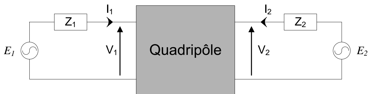
Figure. 2.4 – Conventions pour un quadripôle placé dans un circuit électrique
