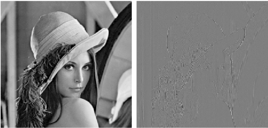
Fig. 3.9: Reconstruction de l'image Lena et image différence après j = 1 filtrage de Haar sur chaque projection de l'ensemble S = \{(16, 1); (8, 1); (4, 1); (-4, 1)\} .
