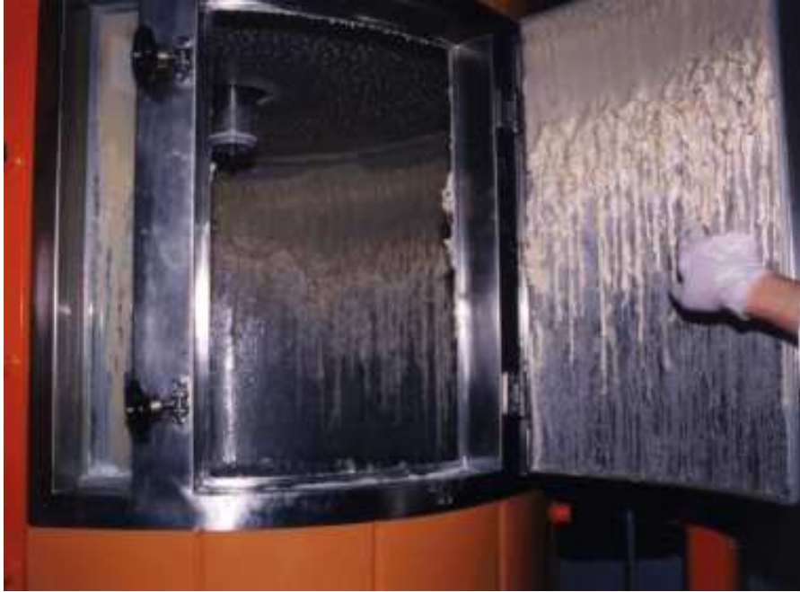
FIG. 6.2 – Vue sur l’atomisateur porte ouverte et sur le collage aux parois y compris celle de la porte.
