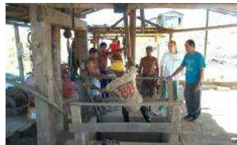
Photo 1.14 : Descente dans le puits du garimpo da cabeça: un câble métallique actionné par un moteur permet d'accéder au filon... 70 mètres plus bas ! (NDVi 2 , juin 2002)
