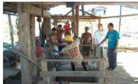
Photo 1.14 : Descente dans le puits du garimpo da cabeça: un câble métallique actionné par un moteur permet d'accéder au filon... 70 mètres plus bas ! (NDVi<sup>2</sup>, juin 2002)
