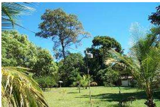
**Photo 2.3 : Vue partielle de la station DAVIS (Weather Monitor 2) installée dans le parc de l'hôtel Floresta Amazônica d'Alta Floresta. Le pluviomètre a été déplacé sur un bâtiment voisin (avec l'anémomètre) suite au constat des mesures de pluies liées au système d'arrosage automatique de la pelouse (NDVi<sup>2</sup>, juin 2002)**
