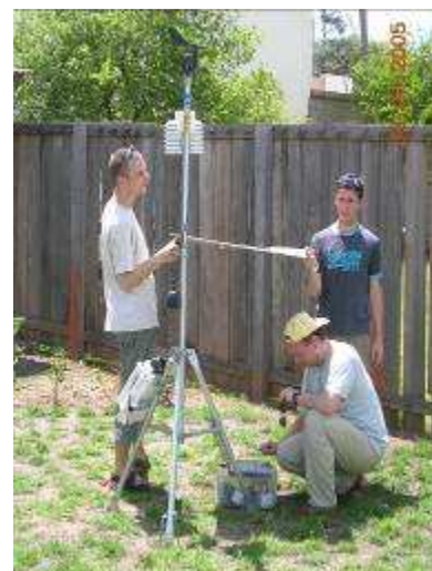
Photo 3.5 : Station « centre ville » de Sinop installée dans la cour des bureaux de l'EMPAER. La forte luminosité vers midi nécessite parfois le recours à des moyens de fortune pour visualiser les données sur l'ordinateur ! ( Photo : H.Potier, juin 2005 )
