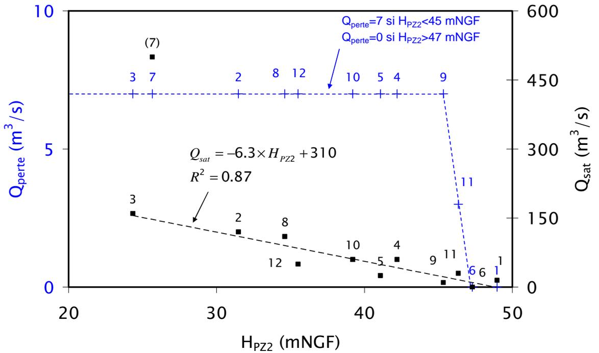
Fig. 111: Expression des paramètres  $Q_{\text{perte}}$  et  $Q_{\text{sat}}$  en fonction de  $H_{PZ2}$
