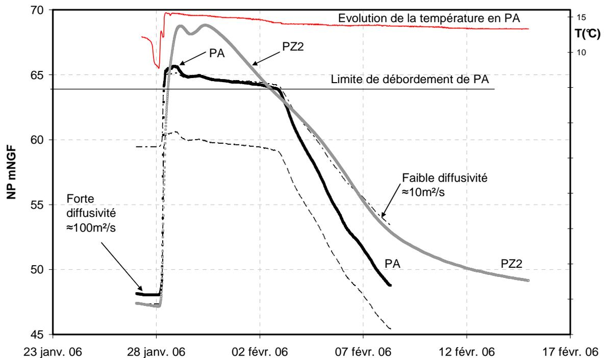
**Fig. 52: Crue 6 - Estimation de la diffusivité du réseau de drainage karstique par la méthode de Pinder et al., [1969]**
