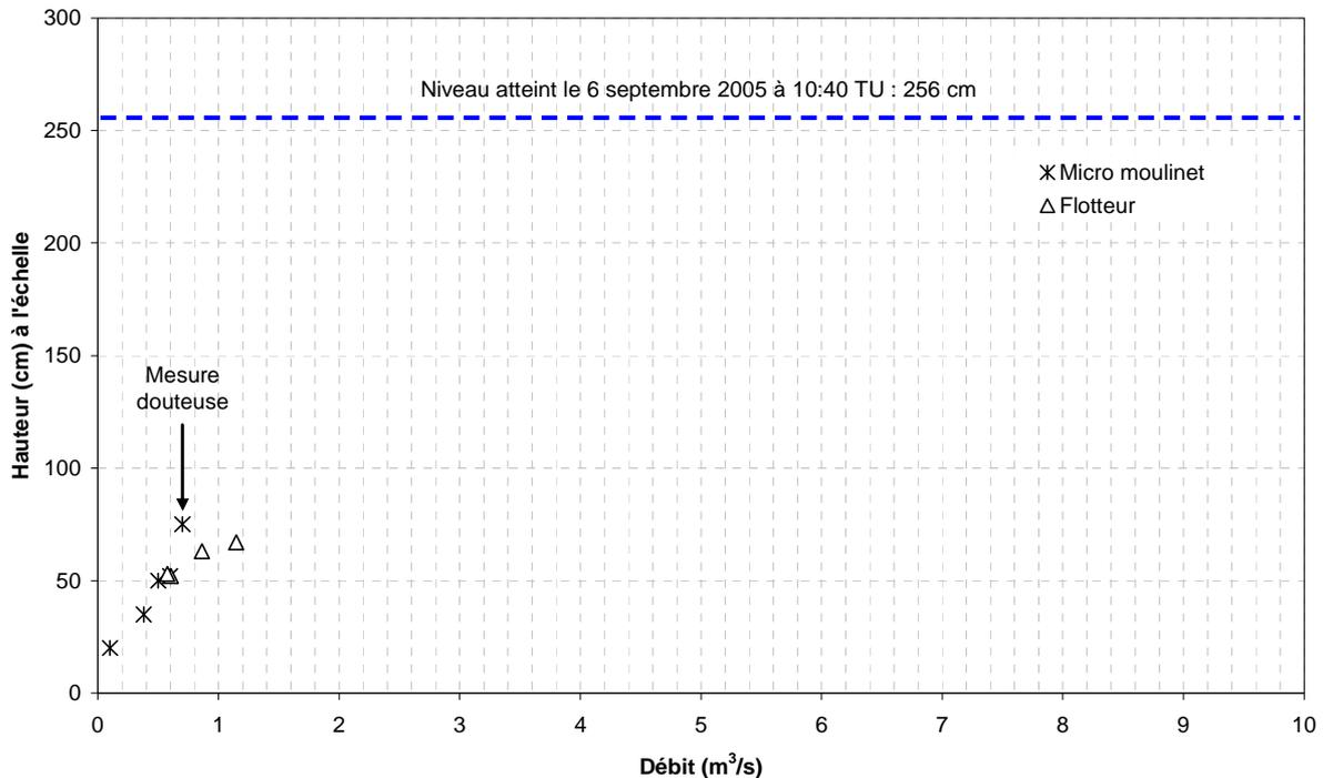
**Fig. 21: Résultats des jaugeages sur le *Coulazou* à la station amont et niveau d'eau maximal enregistré à la station depuis avril 2004.**
