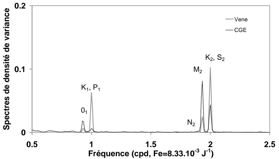
Fig. 95: Analyse spectrale comparée des chroniques piézométriques différenciées
