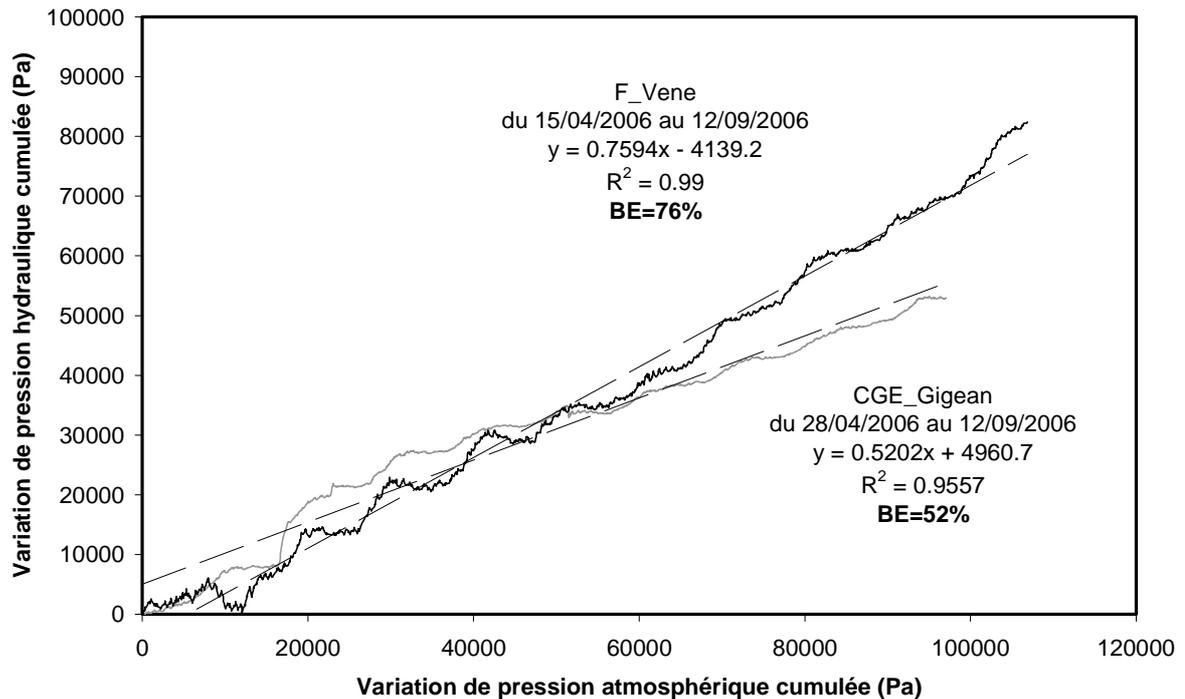
Fig. 98: Estimation de l'efficacité barométrique dans les piézomètres F\_Vene et CGE\_Gigean par la méthode de Clark [1967]
