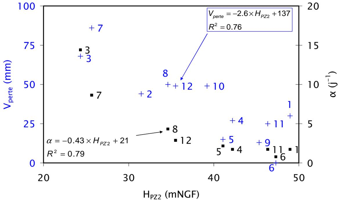
Fig. 110: Expression des paramètres  $V_{\text{perte}}$  et  $\alpha$  en fonction de  $H_{PZ2}$
