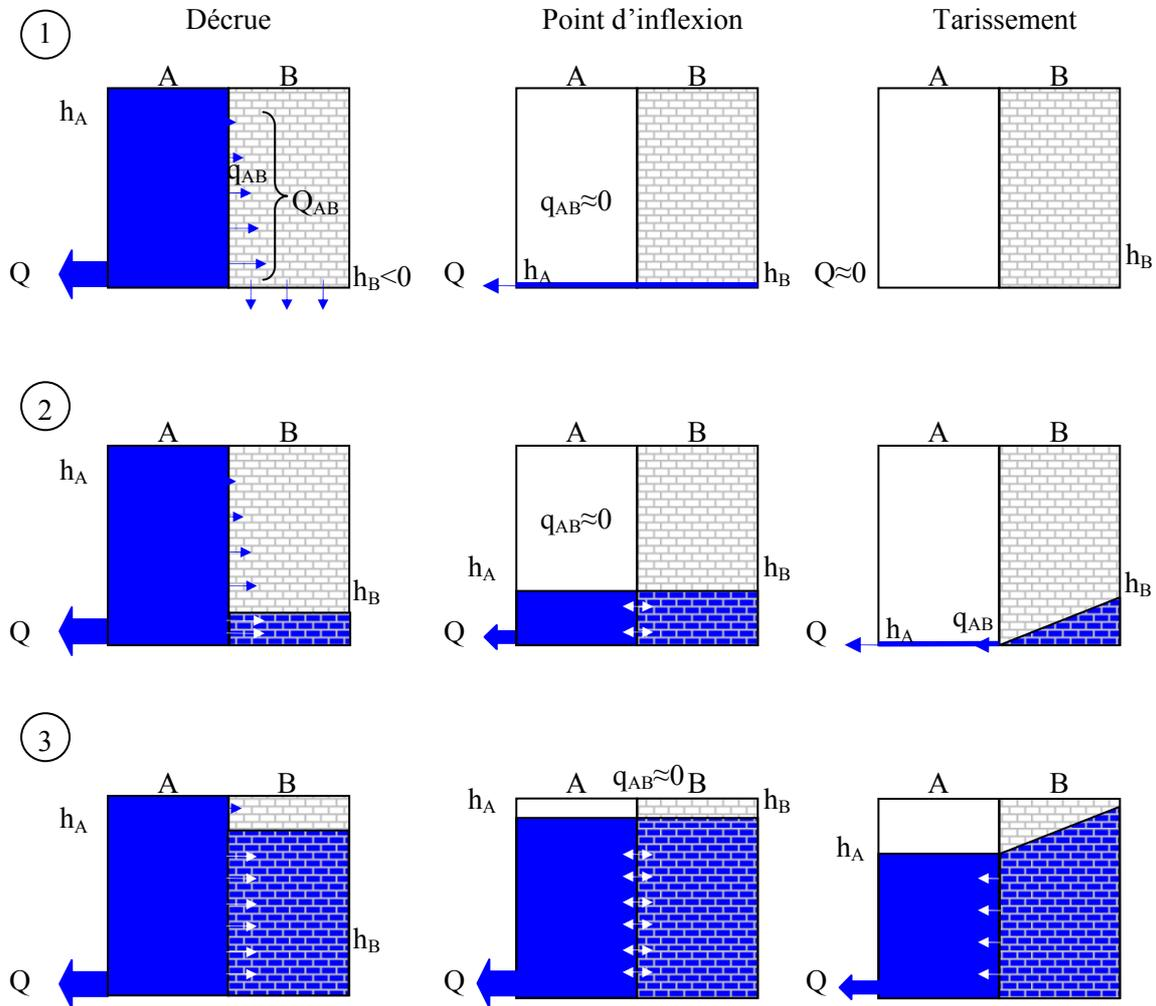
**Fig. 83: Représentation schématique des échanges entre un conduit karstique (élément de gauche) et la matrice peu perméable (élément de droite) lors d'une crue de surface selon les conditions hydrogéologiques initiales : 1=Basses eaux, 2=Niveau intermédiaire ; 3=Hautes eaux.**
