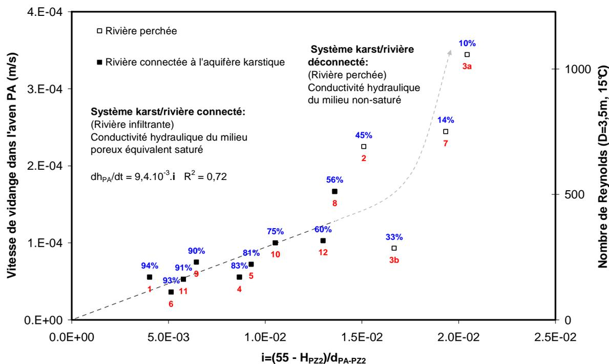
**Fig. 54: Relation entre la vitesse de filtration mesurée dans l'aven PA et la charge hydraulique mesurée en PZ2 avant la crue selon le type de connexion entre la rivière et l'aquifère.** A chaque point est associé le numéro de la crue (bas) et son indice piézométrique (haut)
