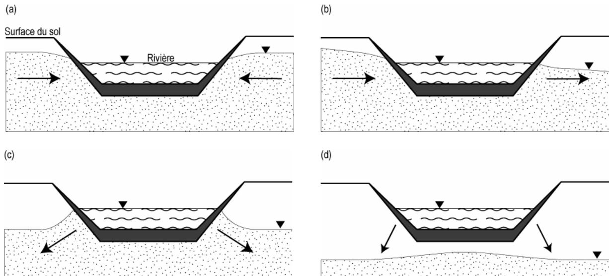
**Fig. 2:** Représentation schématique des interactions aquifère-rivière dans le cas d'un lit semi-perméable. Les flèches indiquent le sens des interactions entre l'aquifère et la rivière. D'après Peterson et Wilson, 1988, cité par Sophocleous [2002], modifié.
