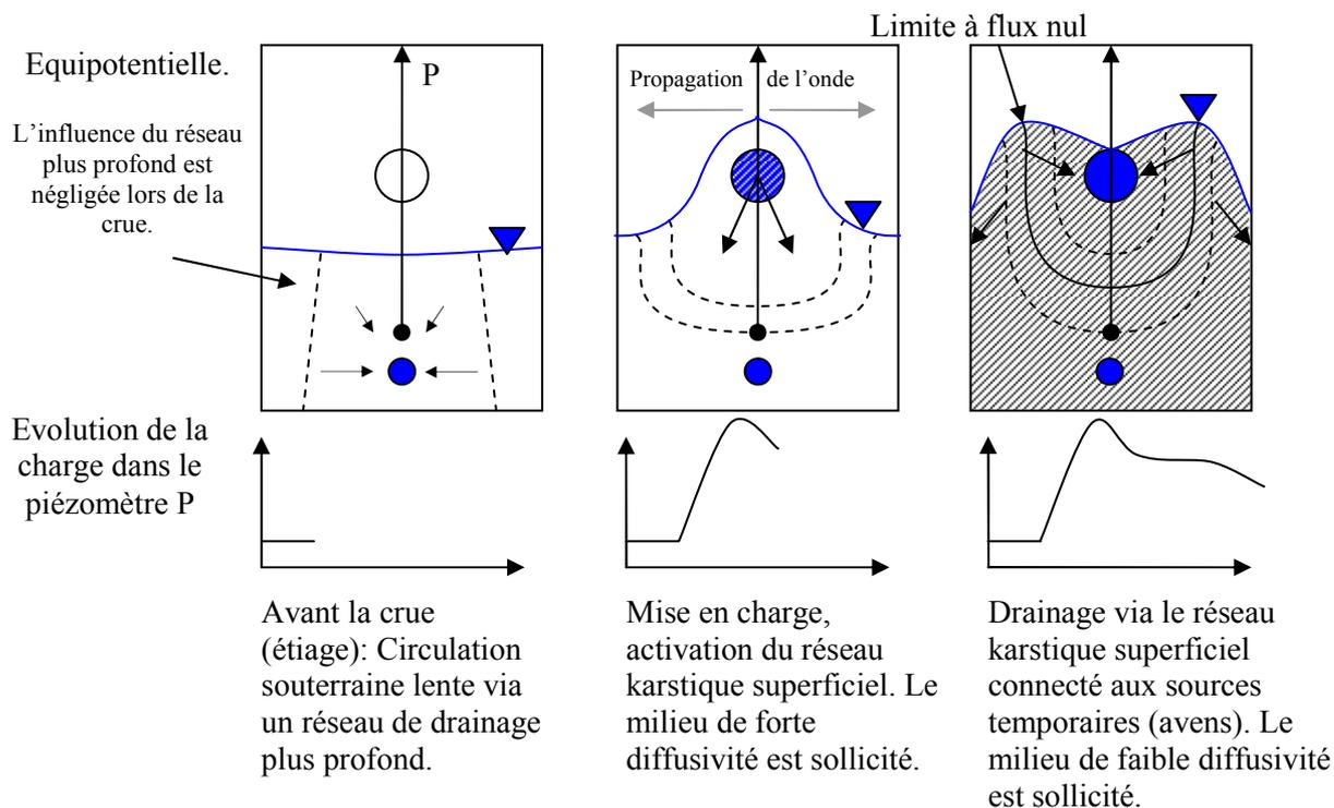
**Fig. 53: Représentation schématique de l'évolution de la piézométrie d'un aquifère karstique sous l'hypothèse d'un milieu à double porosité** - Les flèches courtes symbolisent les sens d'écoulement, le milieu hachuré correspond au milieu sollicité par le transfert de pression.
