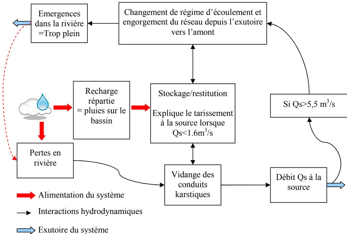
**Fig. 62: Interactions hydrodynamiques rétroactives entre la rivière du *Coulazou* et la source de *la Vène*.**
