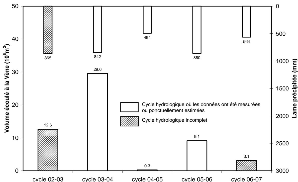
**Fig. 80: Estimation des volumes écoulés à la Vène** ; les cycles sont définis à partir du 1er septembre, les précipitations sont mesurées au pluviographe de Montbazin pour les cycles 02-03 et 03-04 puis en P4 (Mas de Figuière) sur le *Causse d'Aumelas*.
