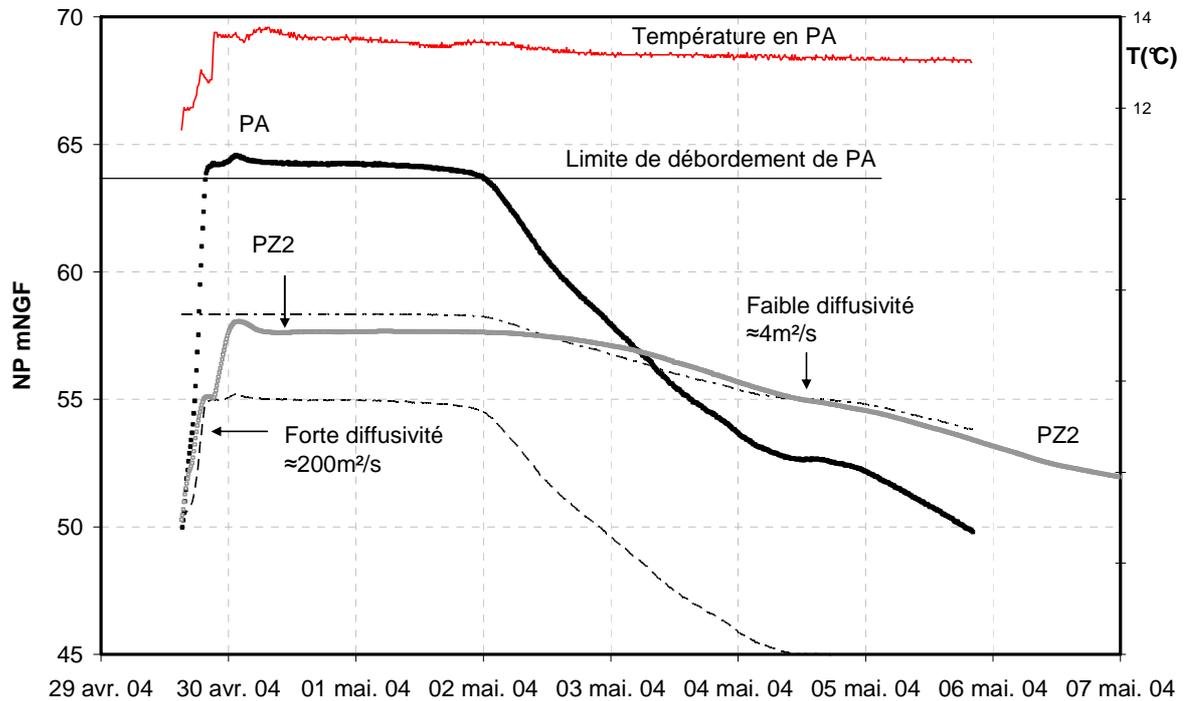
Fig. 50: Crue 1 - Estimation de la diffusivité du réseau de drainage karstique par la méthode de Pinder et al., [1969]
