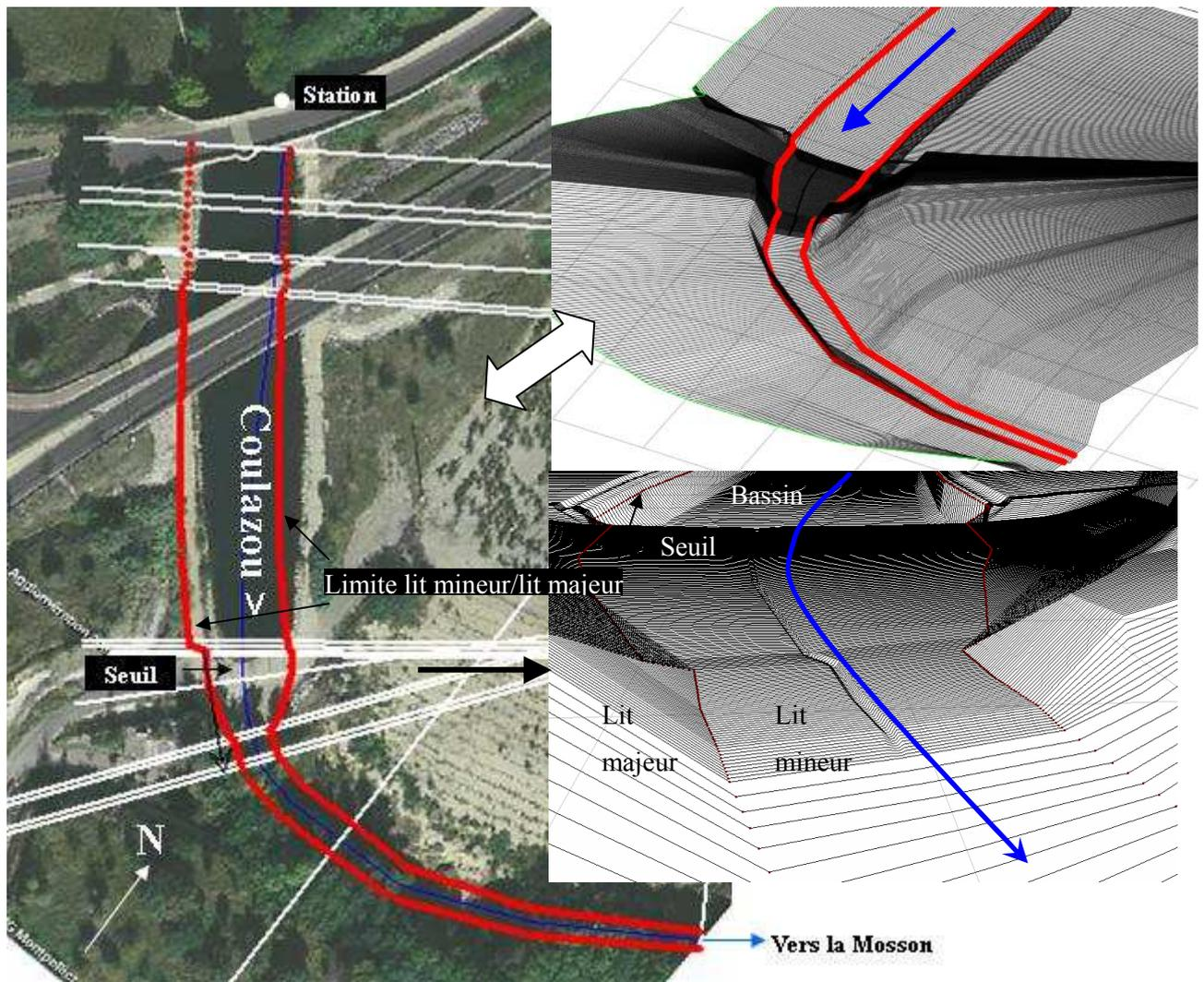
**Fig. 29: Domaine modélisé**, l'ajustement de la photo aérienne avec le modèle permet juste de se repérer dans l'espace, l'écart observé entre le tracé du lit du modèle et le lit réel sur la photo n'a aucune incidence sur le calcul.
