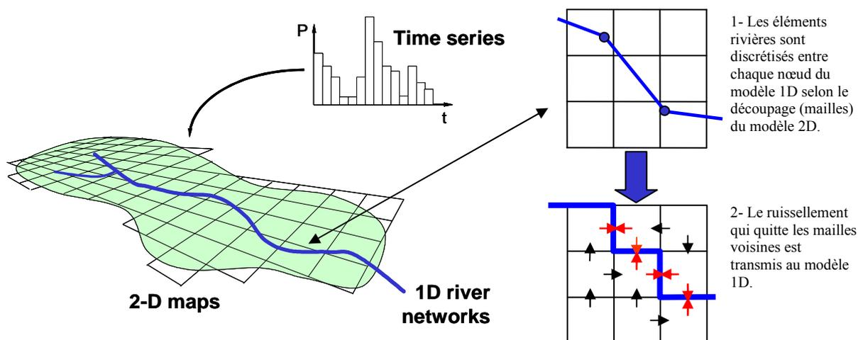
Fig. 6: Couplage du modèle de versant avec le modèle de rivière (cas du couplage Mike-She/Mike 11, source : V.Guinot)
