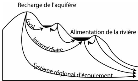
**Fig. 1:** Système d'écoulement local, intermédiaire et régional [d'après Dahl et al., 2007]
