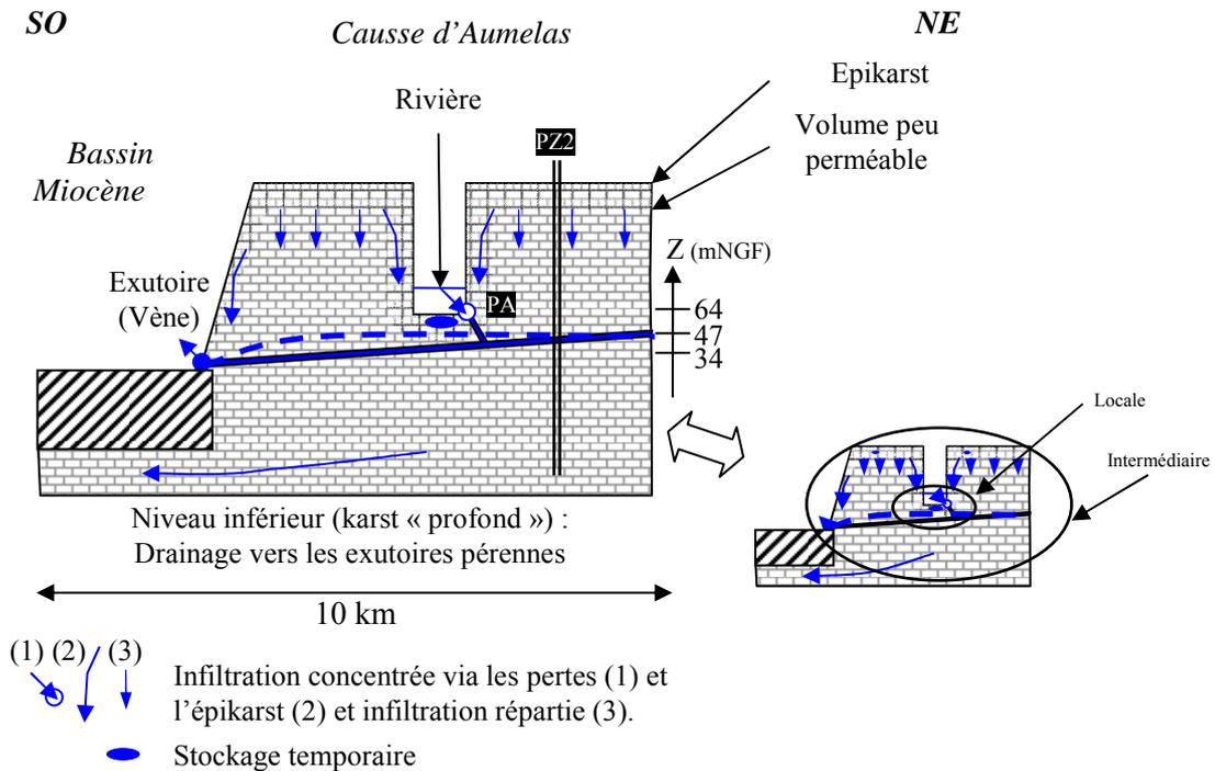
**Fig. 81: Représentation synthétique des interactions karst/rivière aux échelles locale et intermédiaires en situation de rivière infiltrante.**
