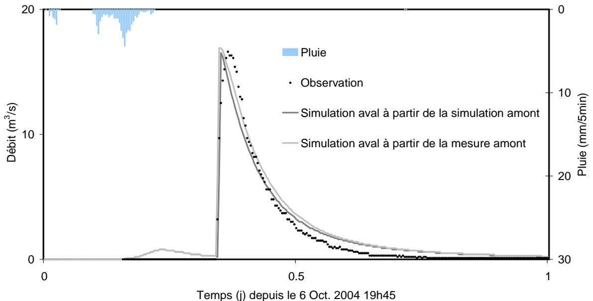
**Fig. 101: Résultat du calage pour la crue 2, sous bassin aval**
