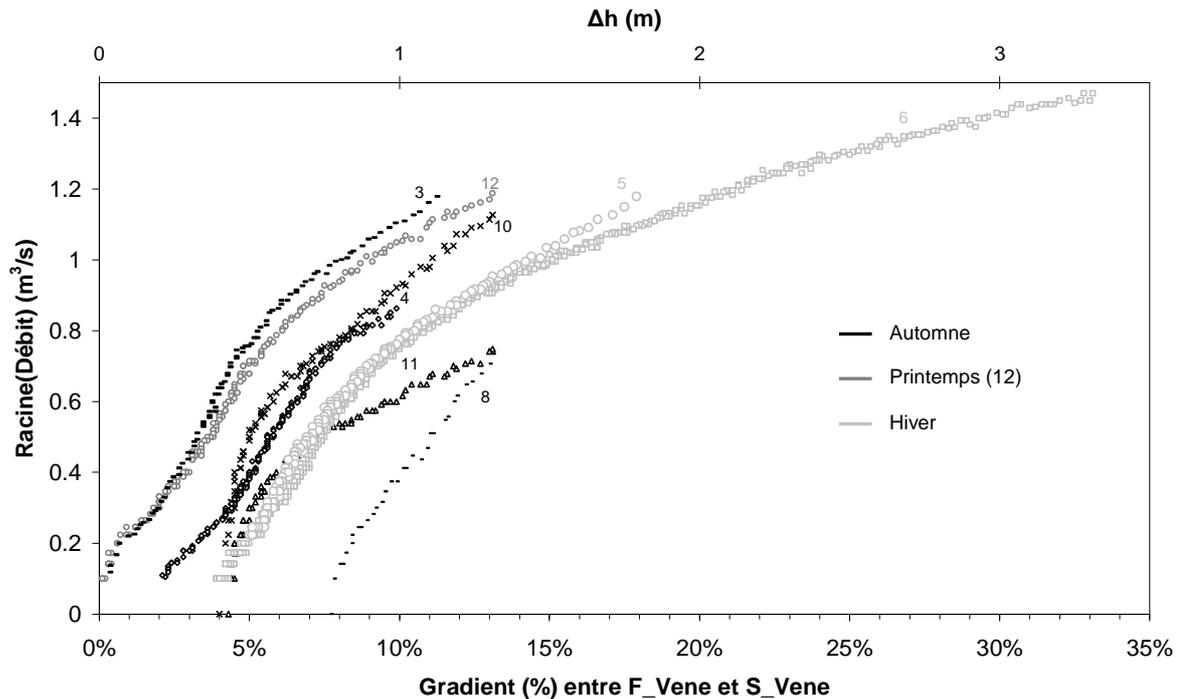
**Fig. 76: Recherche d'une relation quadratique entre le gradient hydraulique et le débit en utilisant F\_Vene et S\_Vene**
