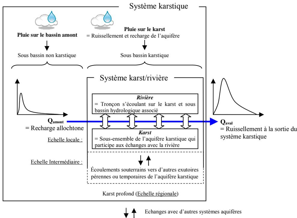
**Fig. 9: Représentation schématique du système karst/rivière**
