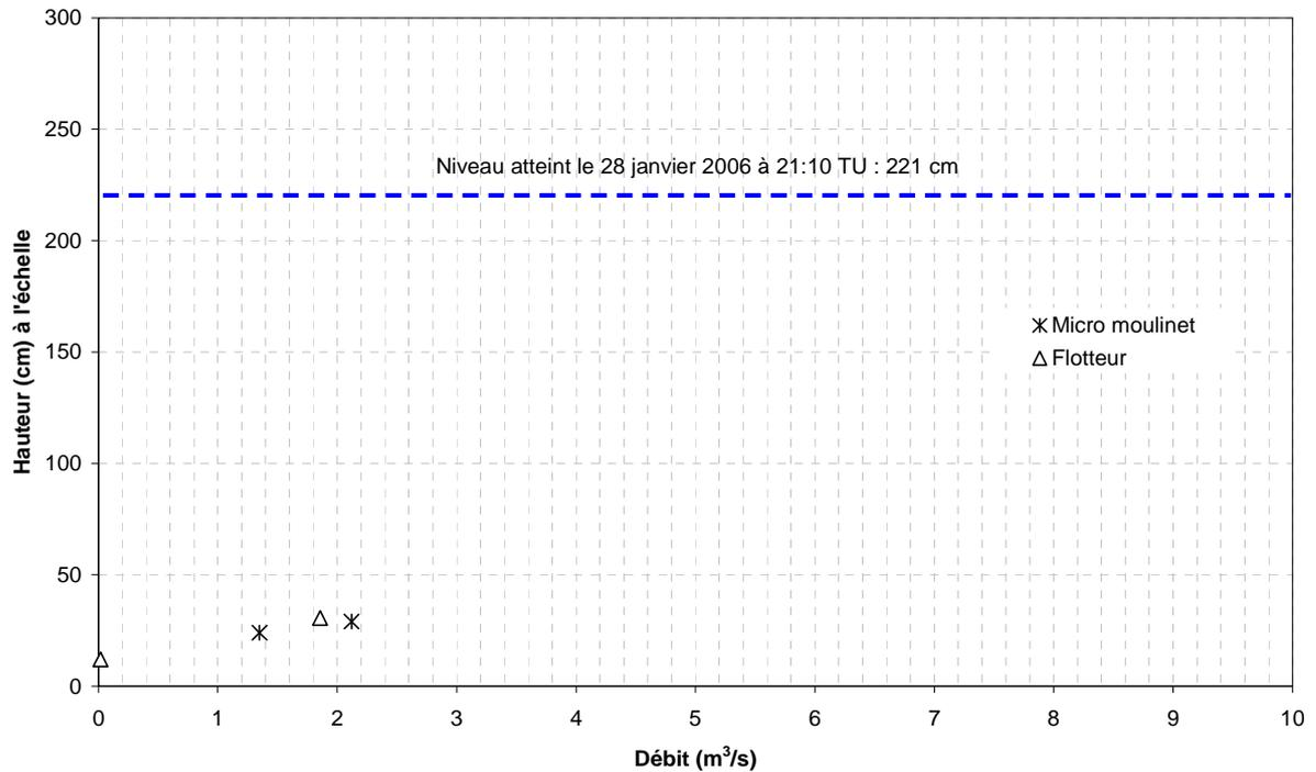
**Fig. 23: Résultats des jaugeages sur le *Coulazou* à la station aval et niveau d'eau maximal enregistré à la station depuis avril 2004.**
