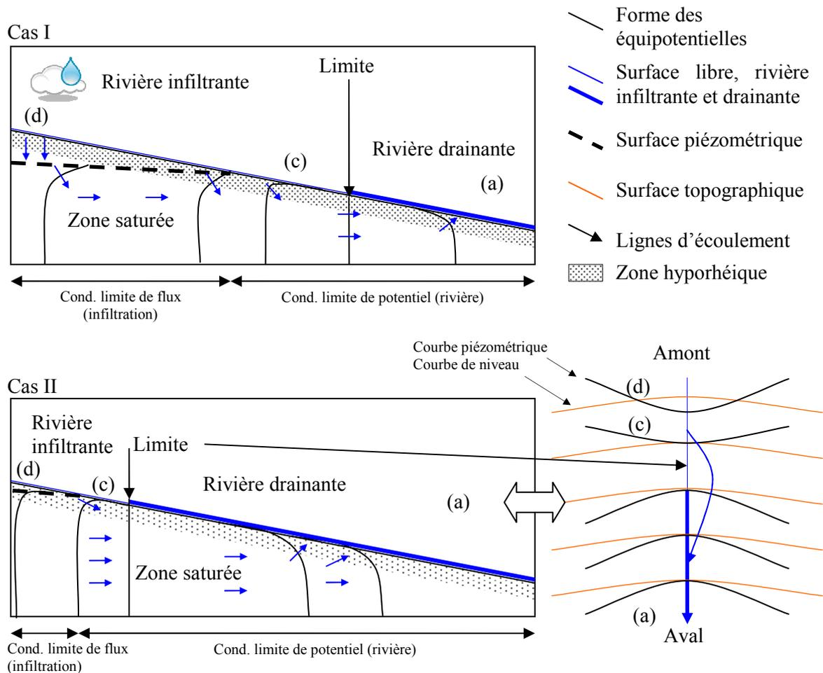
**Fig. 3:** Vue schématique en coupe et en plan de la limite entre une rivière infiltrante et une rivière drainante au début (I) et à la fin (II) d'un épisode pluvieux. Les lettres se rapportent aux cas de la Fig. 2.
