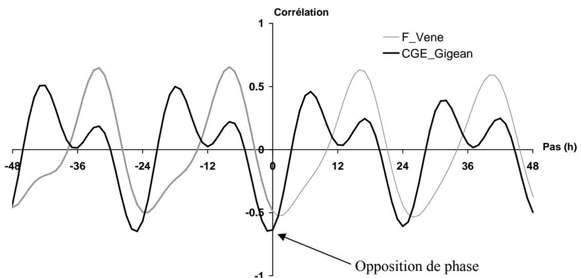
**Fig. 97:** Corrélogrammes croisés entre la déformation volumique (PREDICT) et la piézométrie dans les 2 forages ; pas horaire, troncature à 30 jours, le corrélogramme est affiché pour les décalages inférieurs à 2 jours.
