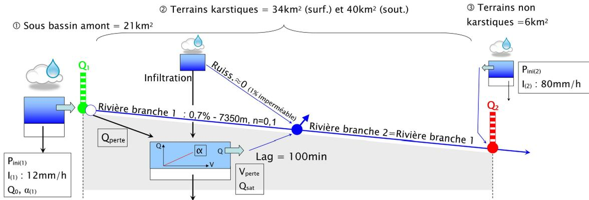
**Fig. 99:** Structure du modèle hydrologique développé sous HEC-HMS, les paramètres de calage apparaissent dans les cadres
