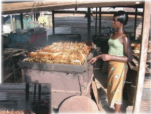
Fumoirs rectangulaires en tôle utilisés par les femmes béninoises pour boucaner la sardine.
