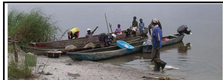
Pirogues des Sénégalais, taillées par les Gabonais avec une poupe droite pour y fixer un moteur
