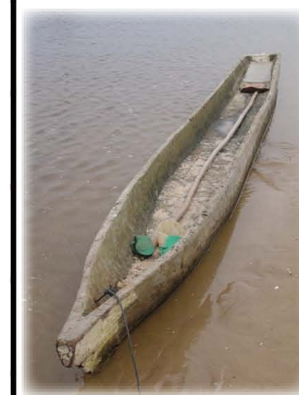
Pirogues des Sénégalais, taillées par les Gabonais avec une poupe droite pour y fixer un moteur
