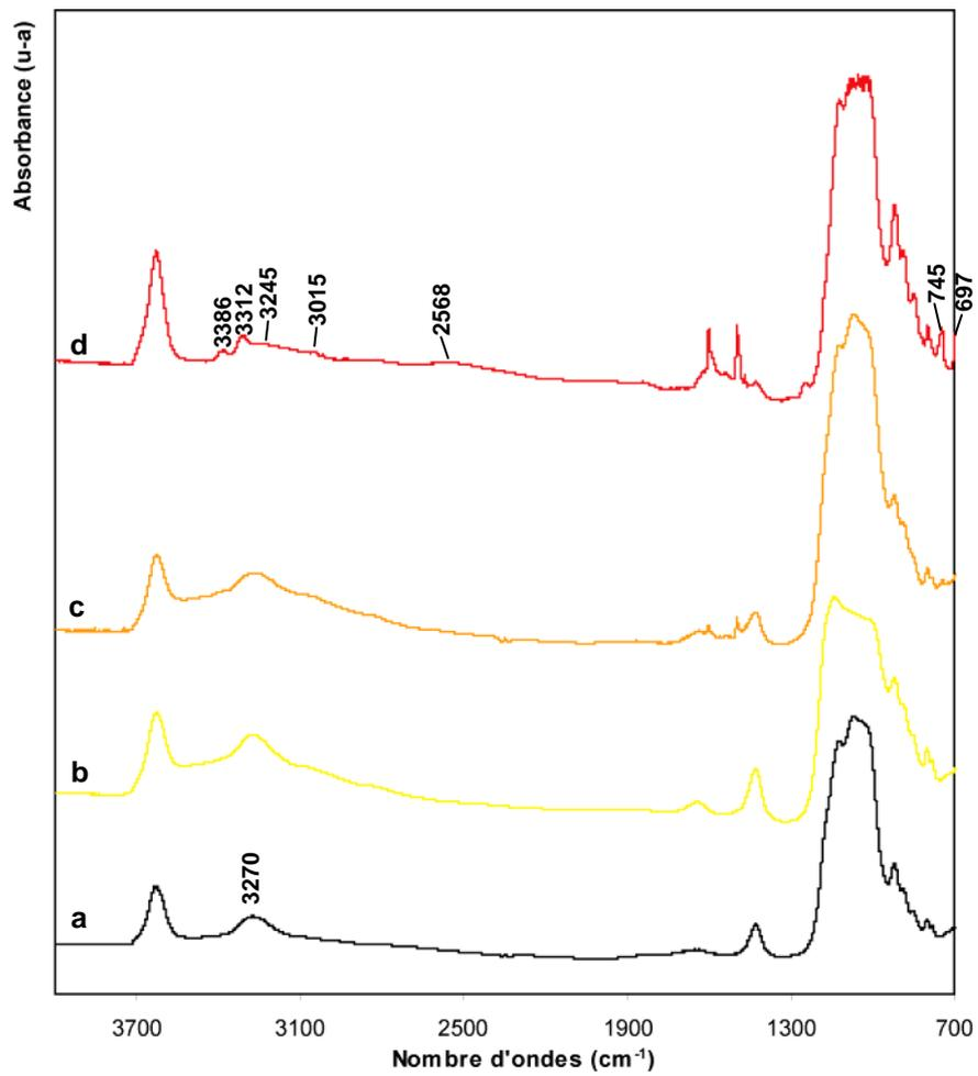
Figure VI.9 : spectres infrarouge de l'argile SWy-2(NH<sub>4</sub>) après 7 jours d'interaction avec l'eau (a, référence), l'aniline en concentration 0,01 mol/L (b), 0,1 mol/L (c) et pure (11 mol/L) (d).
