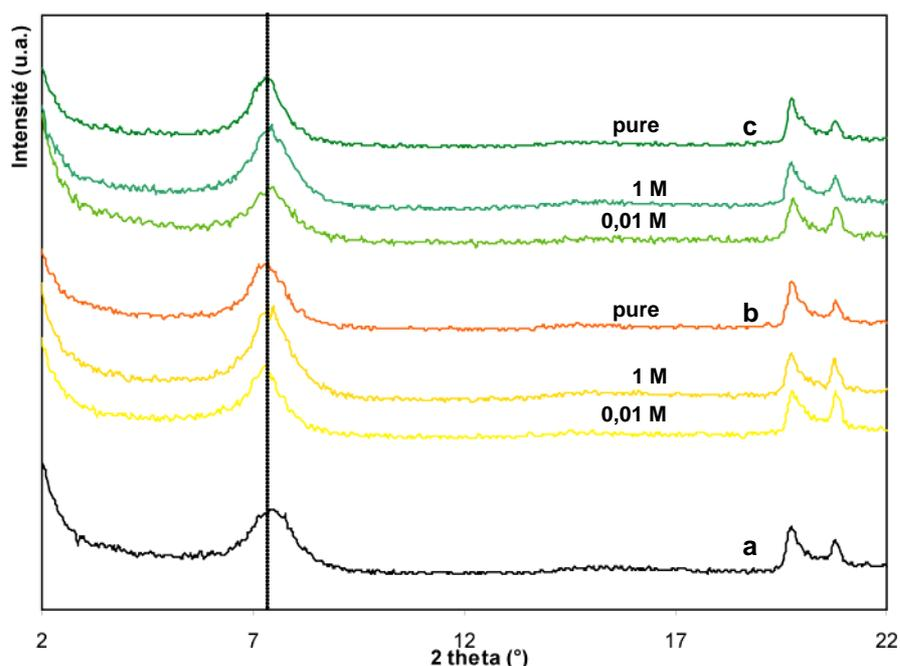
Figure VI.7 : Diffractogrammes des rayons X de l'argile SWy-2(NH<sub>4</sub>) après 7 jours d'interaction avec l'eau (a, référence), l'éthanol (b) et l'acétone (c). Les trois concentrations en molécules sont représentées par des teintes de couleurs croissantes avec la concentration.
