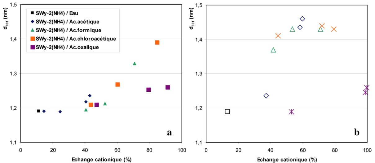
Figure V.30 : Evolution de la distance basale ( $d_{001}$ ) en fonction du taux d'échange cationique après interaction avec chaque acide pour l'argile ammoniée broyée à la main (a) et au broyeur à billes (b).
