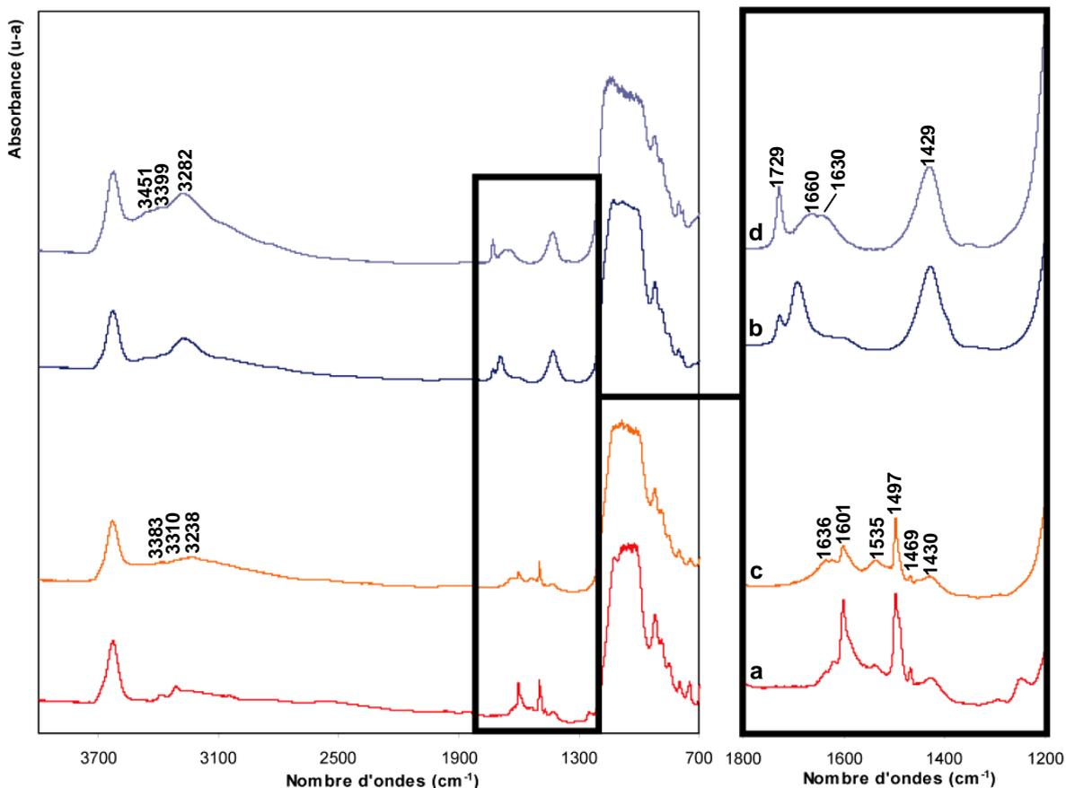
**Figure VI.19 :** Spectres infrarouge de l'argile SWy-2(NH<sub>4</sub>) après 7 jours d'interaction avec l'aniline (a) et le formamide (b) en concentrations pures. Les courbes c et d correspondent respectivement aux argiles après rinçages complémentaires de ces deux échantillons.
