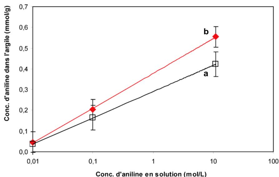
**Figure VI.8 : Isothermes de sorption de l'aniline calculées à partir des analyses en azote (a) et en carbone (b) dans l'argile. La concentration d'aniline en solution est représentée en échelle logarithmique.**
