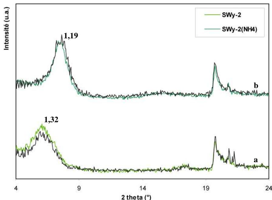
**Figure VII.4 : Diffraction des rayons X de la fraction fine de l'argile SWy-2 (a) et de cette même argile échangée avec l'ammonium (b). Les argiles avant l'expérience d'oedométrie sont représentées en couleur et les diagrammes en noir correspondent aux argiles après l'expérience.**
