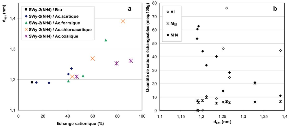
Figure V.18 : a/ Evolution de la distance basale avec le pourcentage d'échange cationique pour l'argile ammoniée après interactions avec les acides acétique, formique, chloroacétique et oxalique. b/ Quantité des espèces dominantes en position échangeable en fonction de la distance basale.
