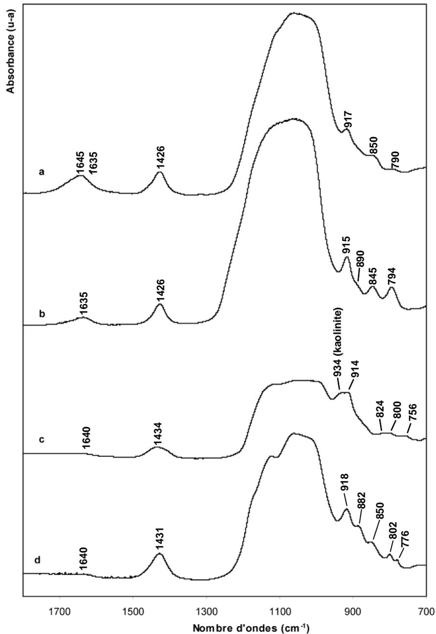
Figure A.4 : Zoom sur la région 700-1800  $\text{cm}^{-1}$  des spectres infrarouges des argiles SAz-1 (a), STx-1 (b), SBId-1(c) et SWy-2 (d) après échange homoionique avec l'ammonium et purification (fraction inférieure à 2  $\mu\text{m}$ ).
