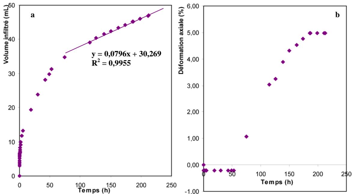
Figure VII.8 : Evolution du volume d'eau infiltrée (a) et de la déformation axiale (b) en fonction du temps pour l'argile SWy-2(NH<sub>4</sub>) traitée avec l'acide oxalique 1 mol/L.
