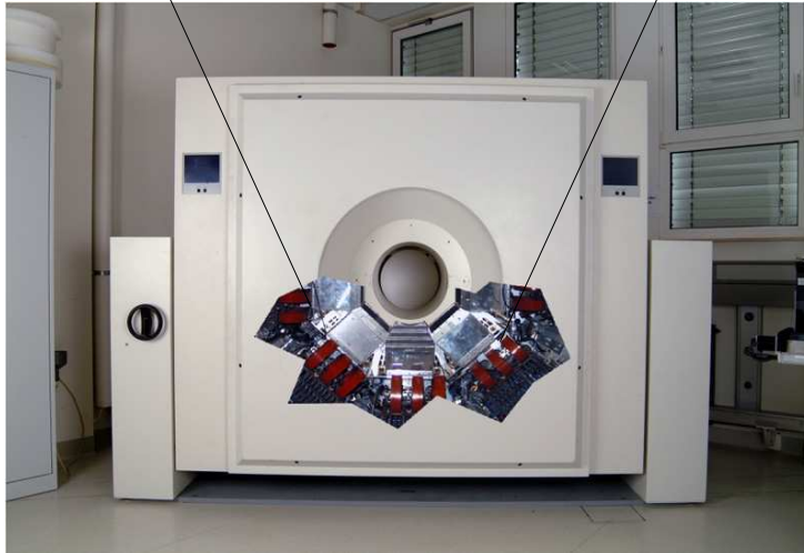
FIG. 1.3 – Acquisition TEP sur le scanner HRRT. Le scanner HRRT est formé de 8 panneaux de détecteurs placés en octogone autour du champ de vue. Un panneau est formé de 13 \times 9 blocs (13 en profondeur et 9 en largeur) de 8 \times 8 \times 2 détecteurs (le HRRT a une double couche de cristaux). Le scanner peut donc être considéré comme constitué de 13 \times 8 = 104 anneaux de détecteurs comme celui représenté schématiquement au dessus de la photo du HRRT de l'institut Max-Planck.
