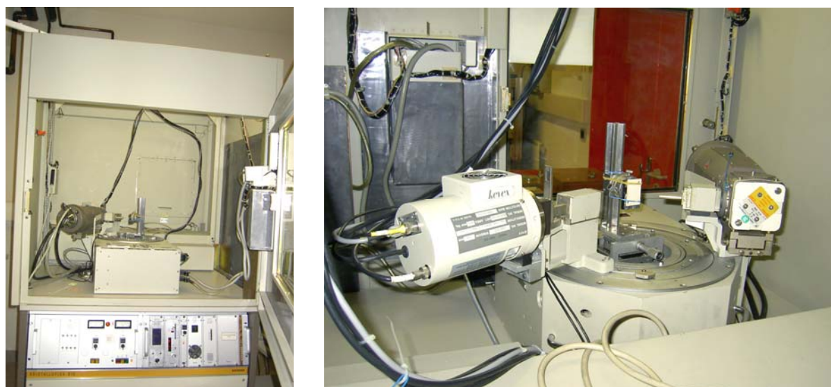
Figure A.1 : Diffractomètre SIEMENS D500.
