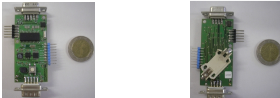
FIG. 6.3: Carte SmartCAN 2 gérant la transmission des données des détecteurs infrarouges sur le bus CAN
