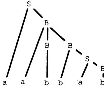
L'arbre de dérivation d'une chaîne du langage est aussi appelé *structure syntaxique* de la chaîne.
