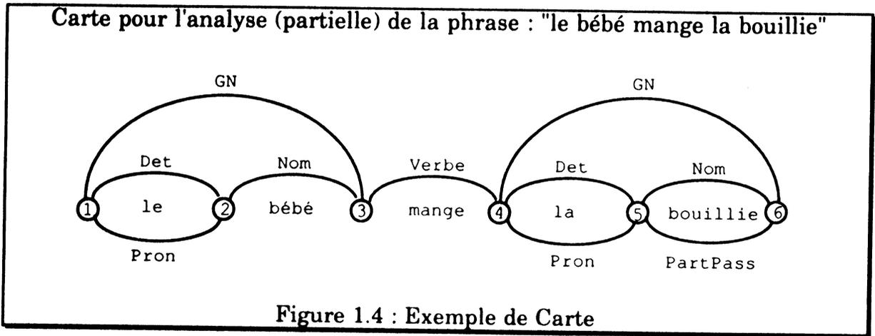
Pour permettre la construction des arbres syntaxiques, les arêtes doivent porter, en plus d'un symbole de la grammaire, la décomposition de ce symbole. Chaque arête porte donc la règle de la grammaire qui a permis de la créer.
