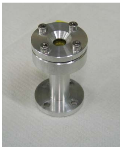
Figure 1 : Support d'échantillon utilisé pour les mesures XMCD au seuil L du Rh
