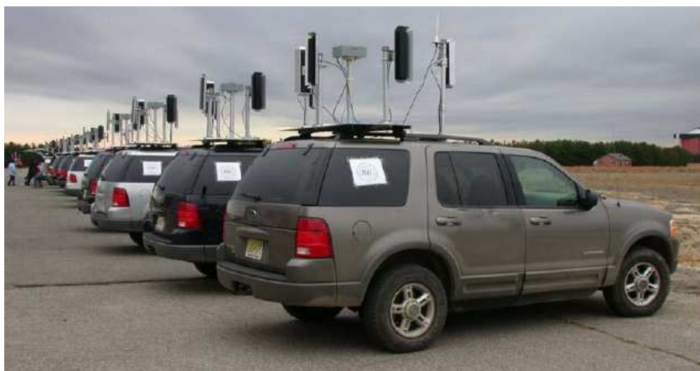
Figure 4.4 – Réseau de véhicules équipés d'antennes directives [Ramanathan 05]
