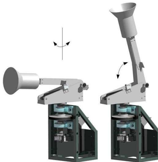
Figure 5.6 – Le modèle CAO de l'antenne de l'infrastructure
