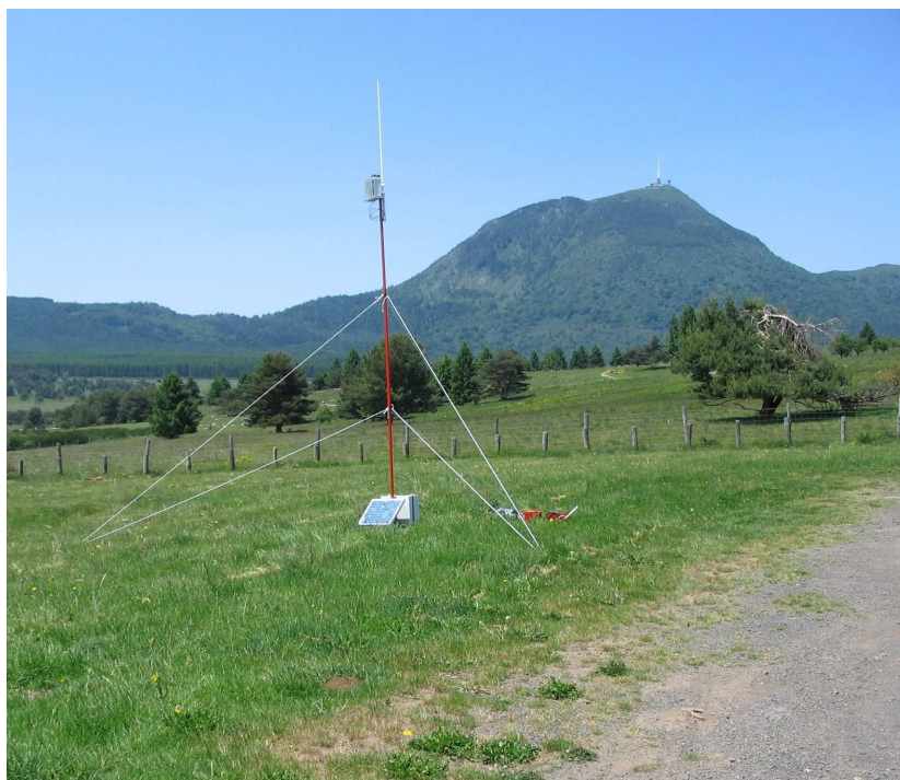
Figure 5.15 – Un exemple de relais autonome pouvant servir de MMRS
