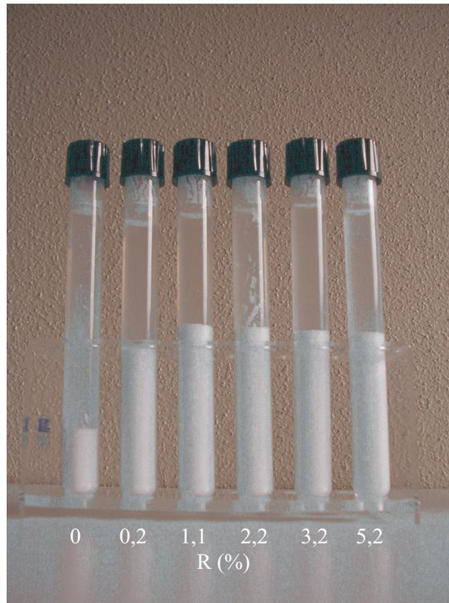
**FIG. 3.6.** Tests de sédimentation pour le système alumine AKP30-silice Ludox TM50 [1].
