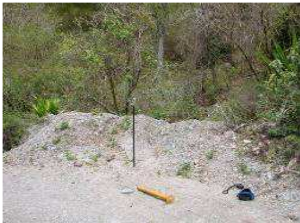
Photographie 66 : Une plaquette de dépôt installée sur la piste menant au captage révèle la présence de fibres de trémolite dans l'air (Photo auteur)
