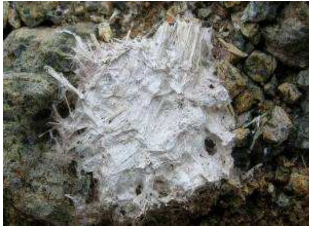
Photographie 72 : L'antigorite altérée se présente sous la forme d'un matériau blanc d'aspect argileux qui rappelle les produits d'altération de la trémolite (Photo Bernard Pelletier)
