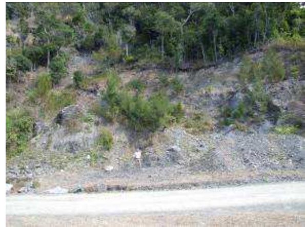
Photographies 35 et 36 : Des carrières contenant des minéraux fibreux sont dispersées le long de la piste entre les tribus de Tendo et Ouayaguette. Ces matériaux servent à empierrer les pistes (Photos auteur)
