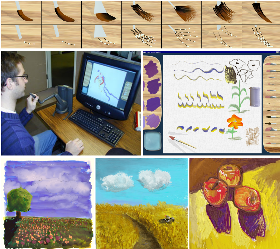
FIGURE 7.2 – Images tirées des travaux de Baxter et coll. [BSL01, BLL04, BWL04]. La première ligne montre le modèle de pinceaux pour différents outils. La seconde ligne présente le système d'interaction ainsi que l'interface du logiciel. La troisième ligne montre quelques résultats.
