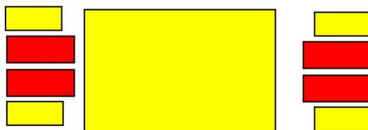
**Figure 1-14 : dispositif magnétique de type RAIMI avec contacts en matériau amagnétique (rouge) décorrésés des aimants fixes (jaunes) (bobine non représentée)
