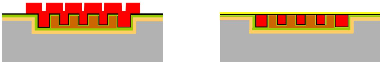
**Figure 3-5 : process flow Nanomag : détournage du matériau magnétique, planarisation, dépôt d'une couche de protection**
