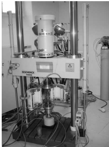
Figure II.1: Machine de compression utilisée pour les essais.
